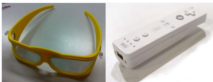
圖 13：左/有 IR LED 燈的偏光式立體眼鏡 右/WiiMote 無線操控器
