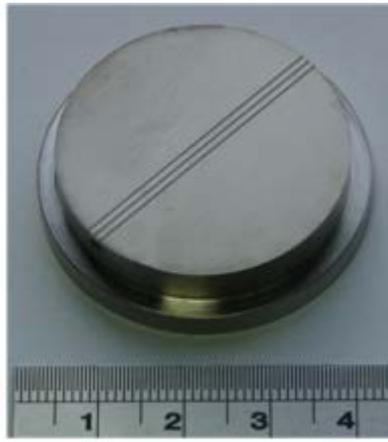
圖 4.32 V 溝結構模仁成品
