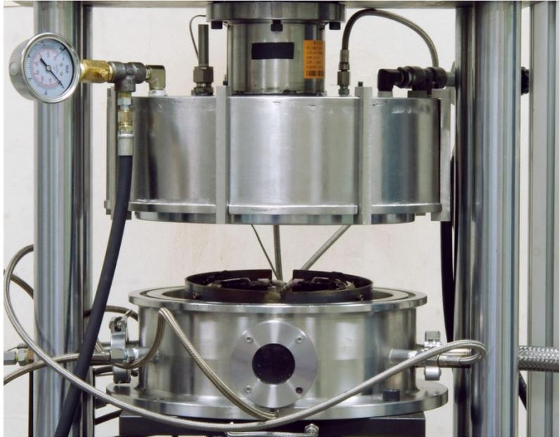
圖 1.9 第二代紅外線真空加熱爐外觀圖
