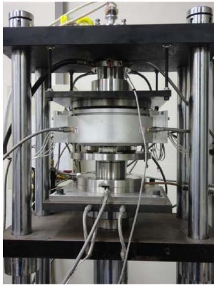
圖 4.24 新型超音波玻璃熱壓成形設備
