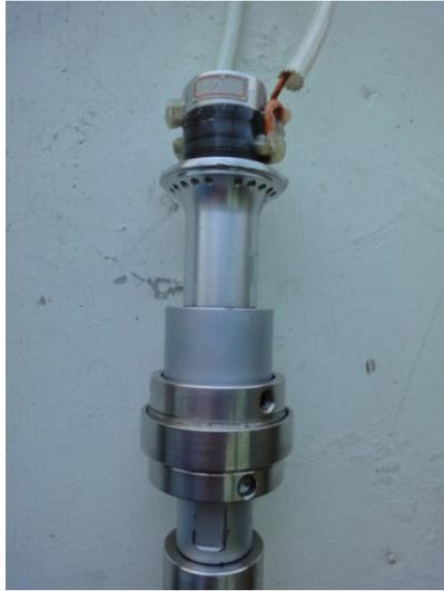
圖 4.21 35 kHz 超音波換能器與聚能器
