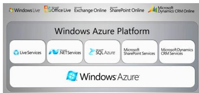
圖五、Windows Azure 的應用與平台架構 (節錄自[20])。
