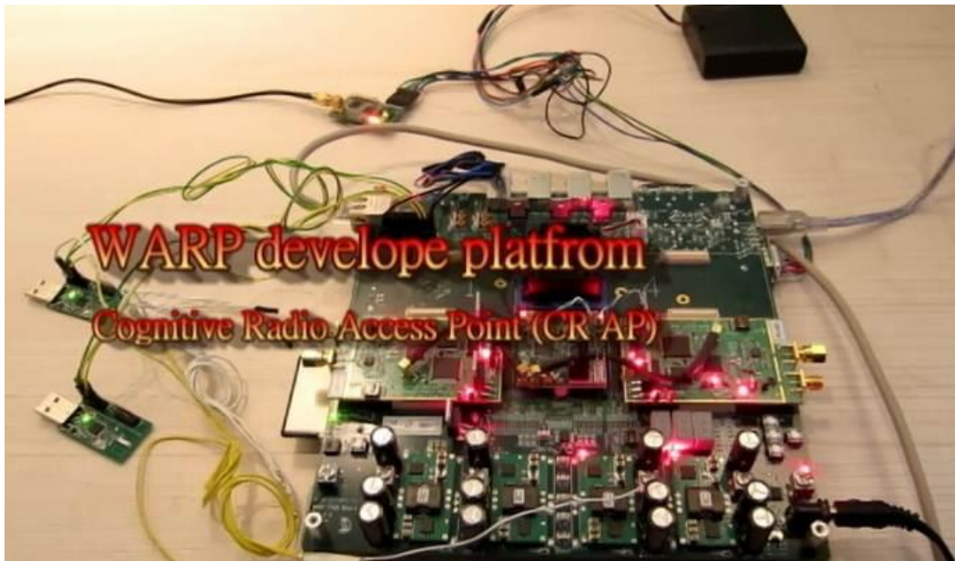
圖十、WARP 開發平台接上 CC1111s 及 HMTR 作為我們的 CR AP
