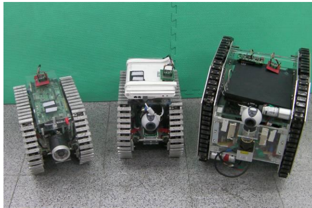
圖 2-1 硬體平台(左邊、中間:第三代機器人，右邊:第二代機器人)
