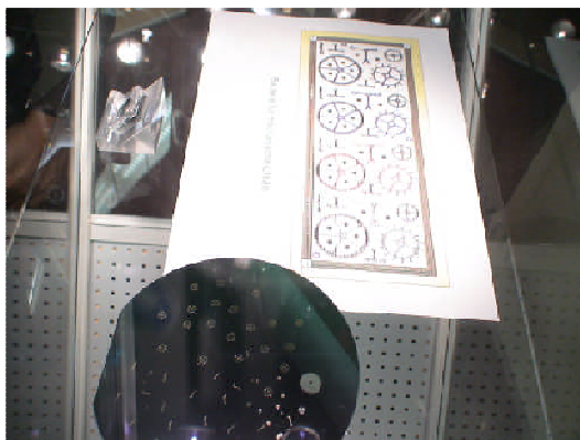
圖 10-13 製作於晶圓上之微型鐘錶元件模仁及其藍圖
