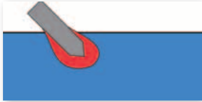
圖 2 馮卡門針對入水問題所提出的附加質量概念，這是個簡化的理想狀態。圖中的紅色區塊代表「附加質量」，這是隨著楔形拋體的運動而運動的流體質量。位於靜止水面上方的（紅色）附加質量，稱為堆積（pile up）。
