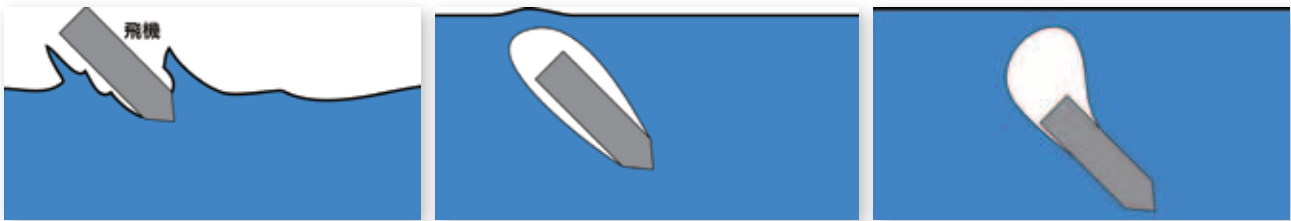
圖 3 根據 Mackey[Mac79]，拋體入水各階段如下：(a) 空氣腔打開；(b) 拋體完全潛沒，被氣囊空腔包住；(c) 空氣腔與拋體分離，拋體完全被水包圍。空氣腔內可能殘留一些水蒸氣，而且常會產生氣蝕效應。(改編自 [Abr11, p.060803-2])
