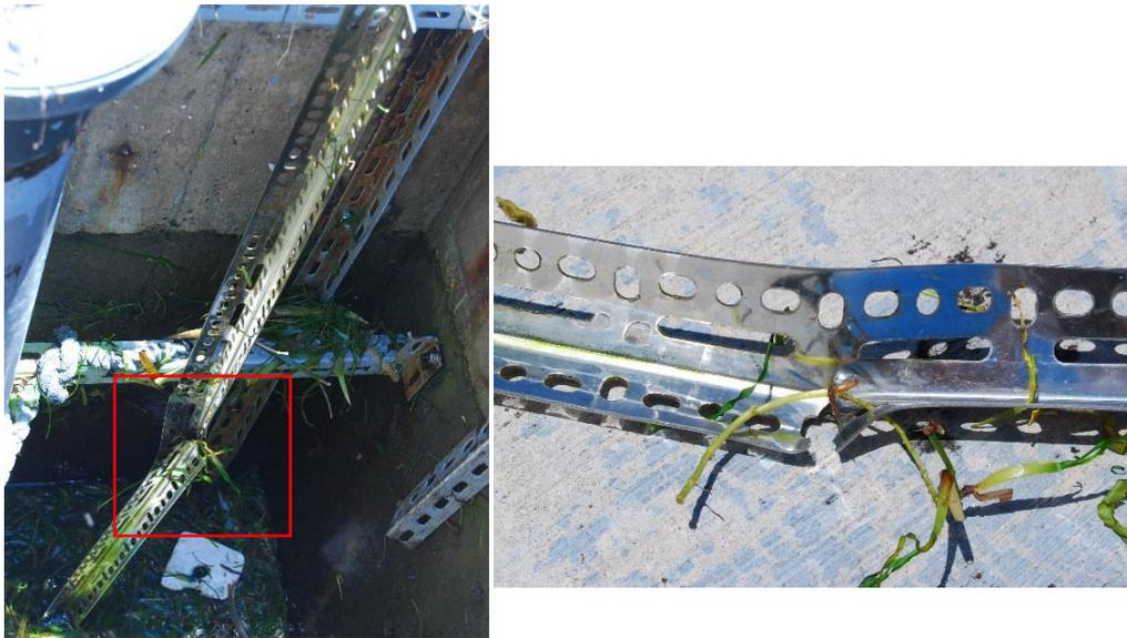
圖 4-6 自記式潮位計支架斷裂
