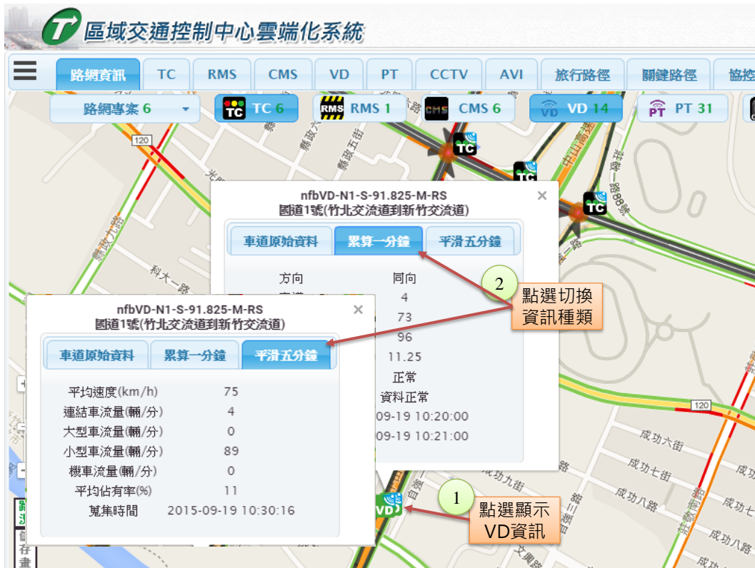
圖 4.3-3 查詢 VD 設備即時交通資訊累算一分鐘與平滑五分鐘作業圖
