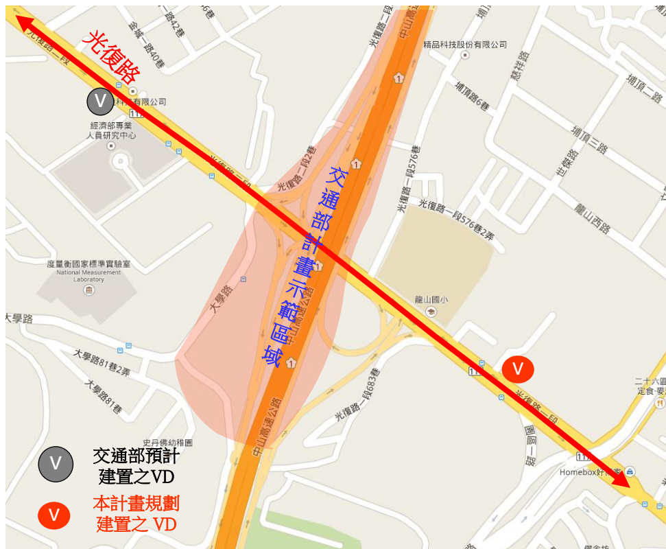
Figure 4 光復路新增車輛偵測器佈設位置
