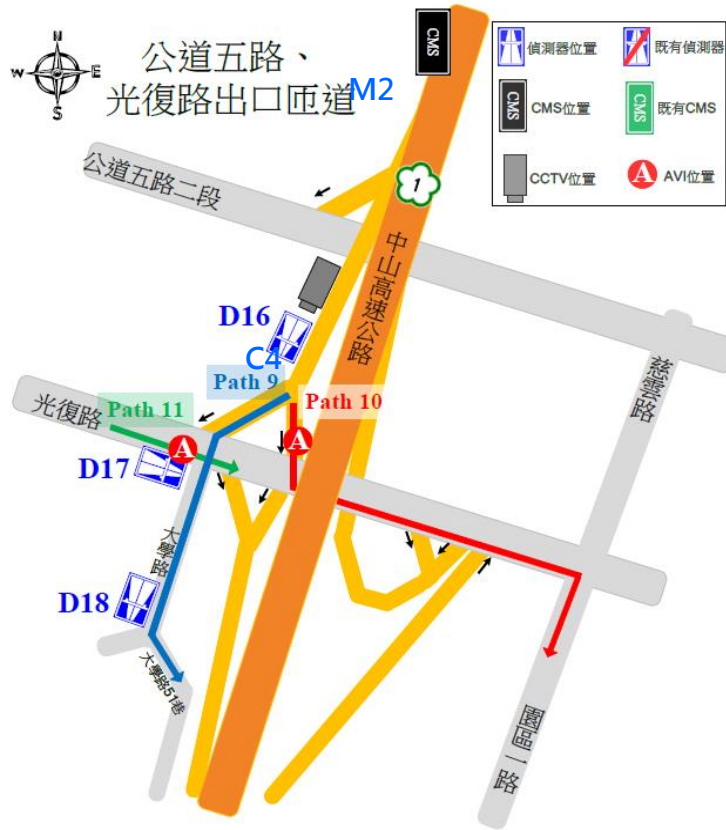
Figure 3 光復路與公道五路交流道地區主要設備佈設位置
