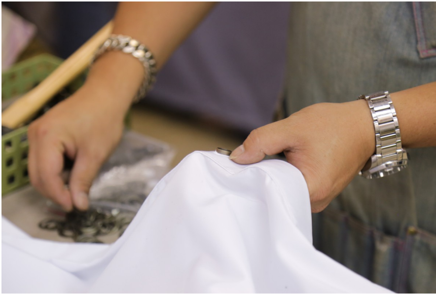
此為劇場布幕，老闆正在裝入鐵製扣環準備敲打，讓布幕能順利掛在劇場的掛鉤上。（照片來源／韓舒容攝）
