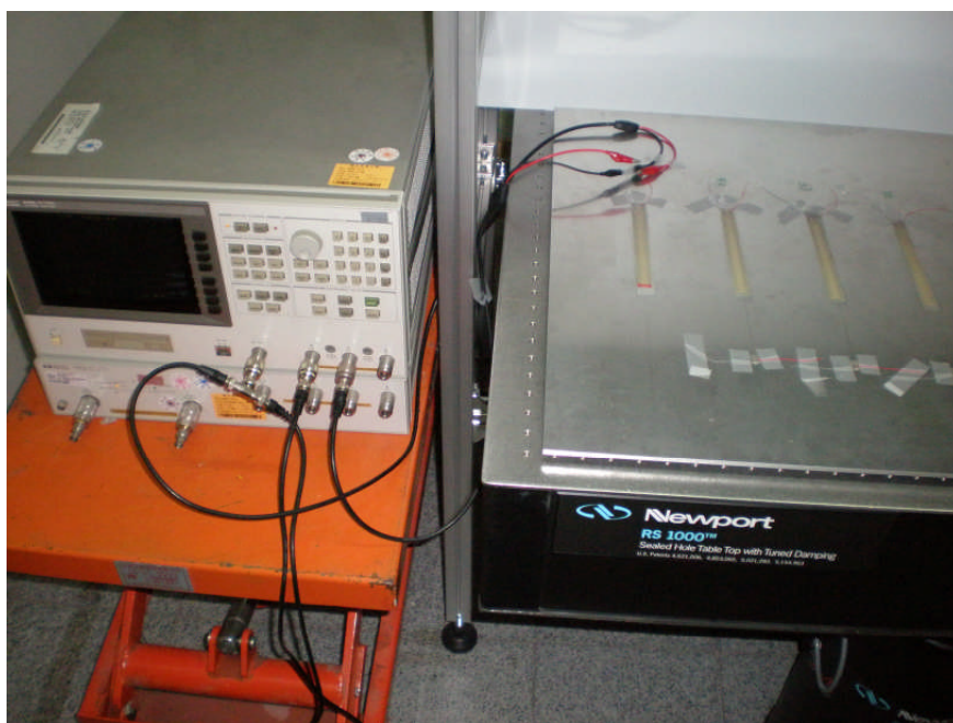
圖 3.7 壓電纖維複材之脫層實驗阻抗量測
