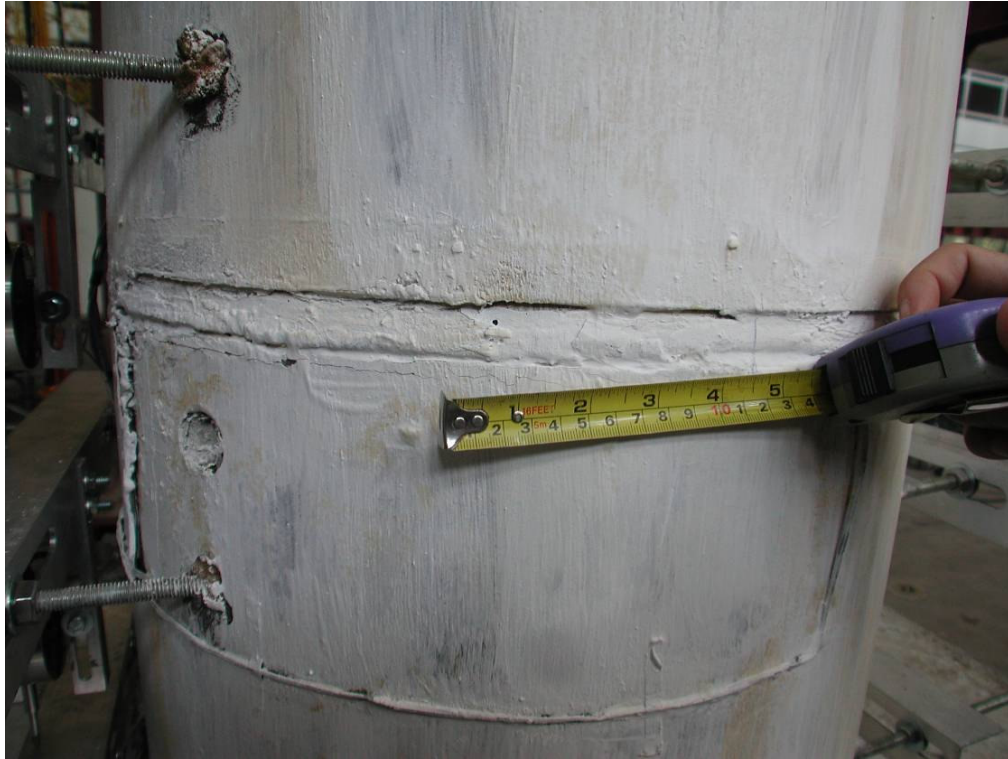
照片 3.29 試體 2 第一、二節塊間裂痕持續增長( \theta = +0.009 弧度)
