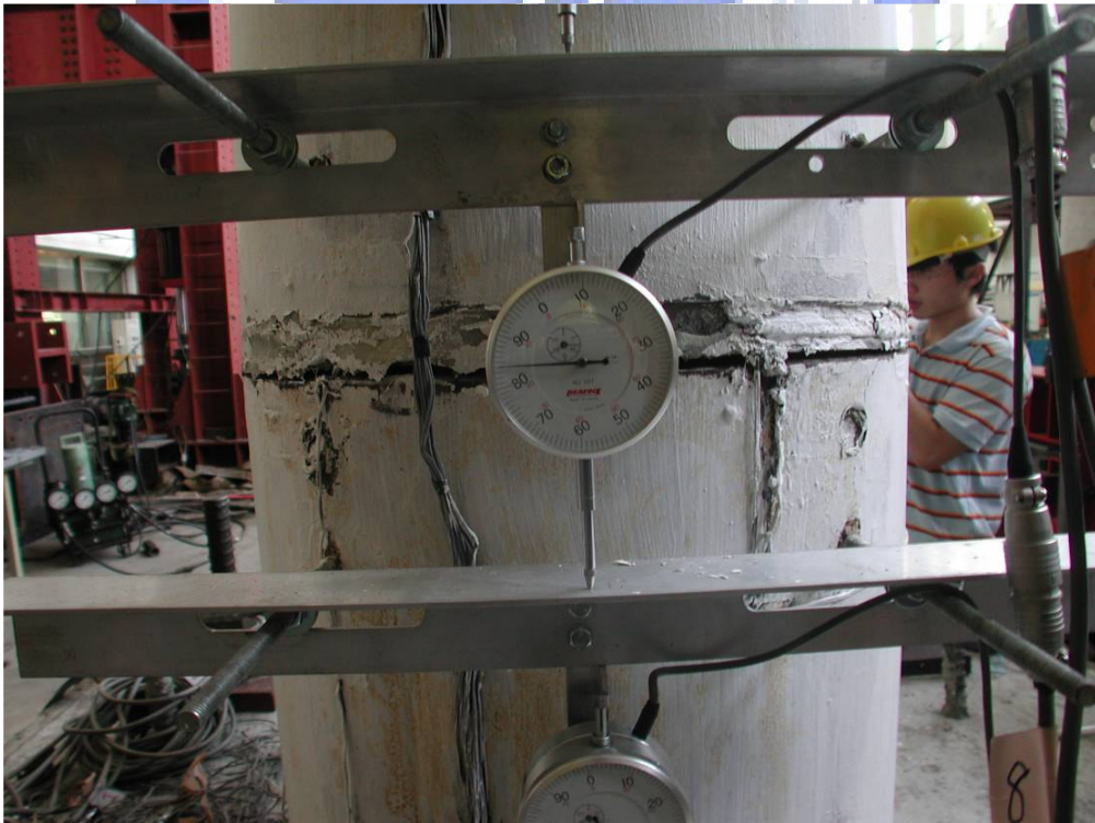
照片 3.44 試體 2 第一、二節塊間撓曲裂縫( \theta = +0.04 弧度)
