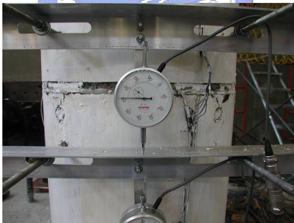
照片 3.56 試體 2 第一、二節塊間受壓側混凝土剝落( \theta = +0.06 弧度)
