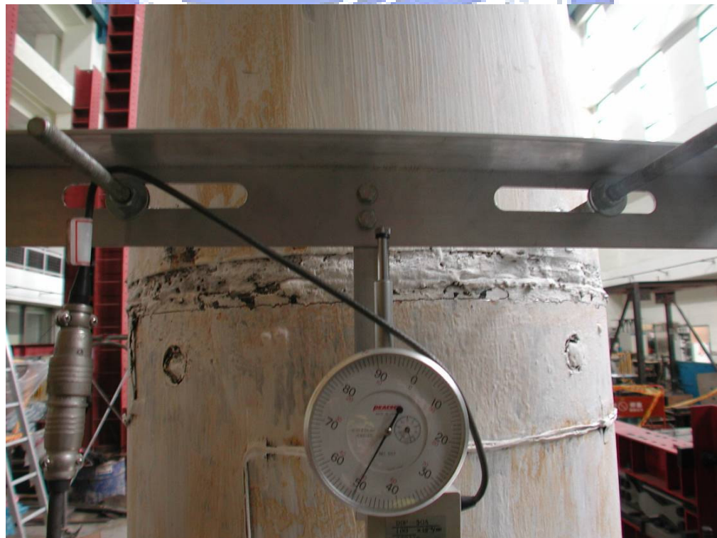
照片 3.80 試體 3 第二、三節塊間撓曲裂縫( \theta = +0.03 弧度)
