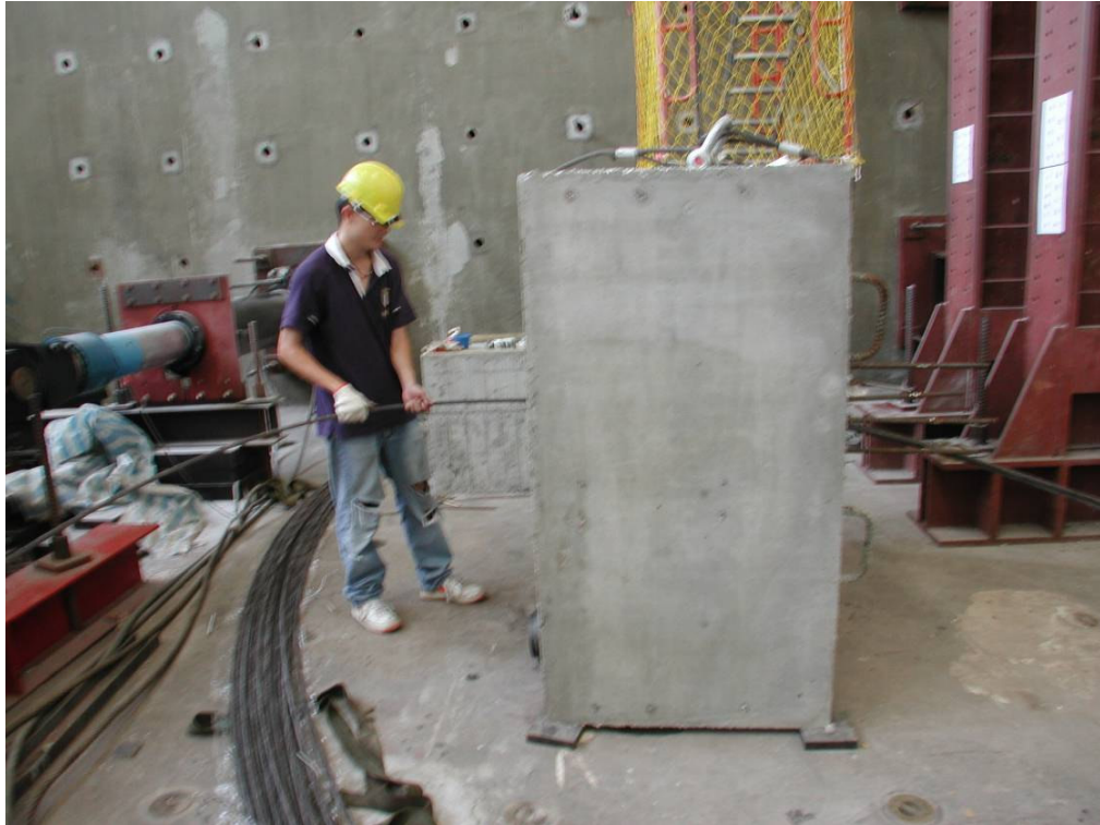
照片 3.13 翻轉基礎並將鋼絞線固定於基礎底部
