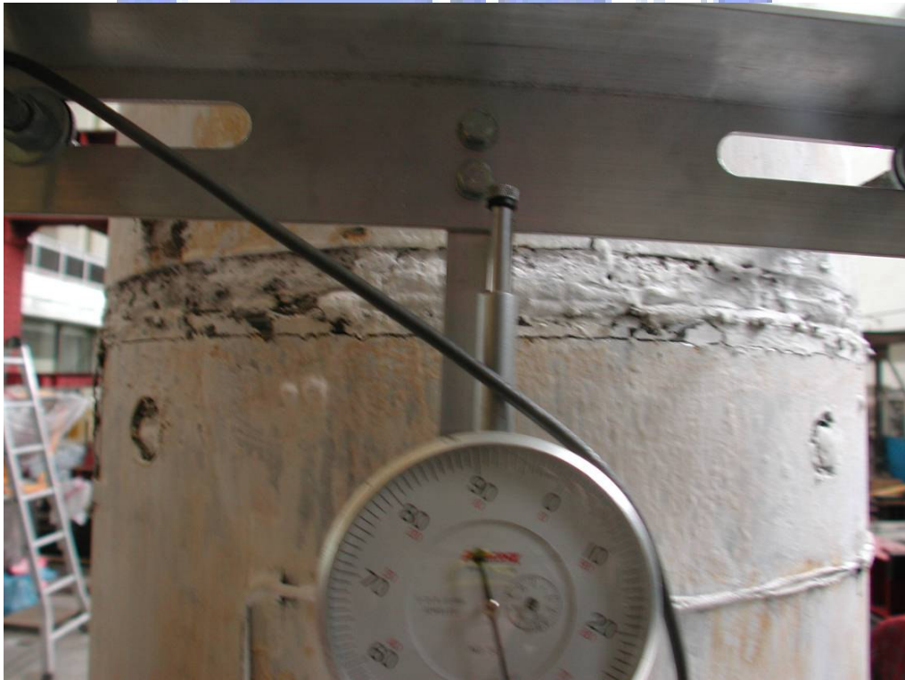
照片 3.86 試體 3 第二、三節塊間撓曲裂縫( \theta = +0.04 弧度)
