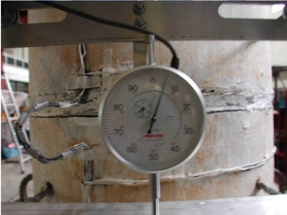
照片 3.90 試體 3 第一、二節塊間撓曲裂縫( \theta = +0.05 弧度)
