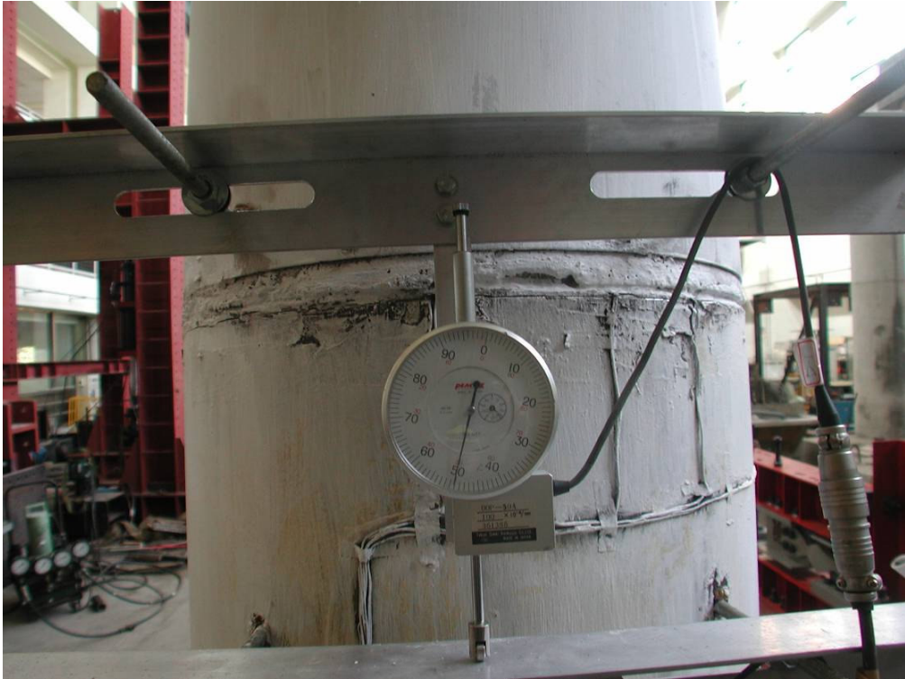
照片 3.57 試體 2 第二、三節塊間撓曲裂縫( \theta = +0.06 弧度)
