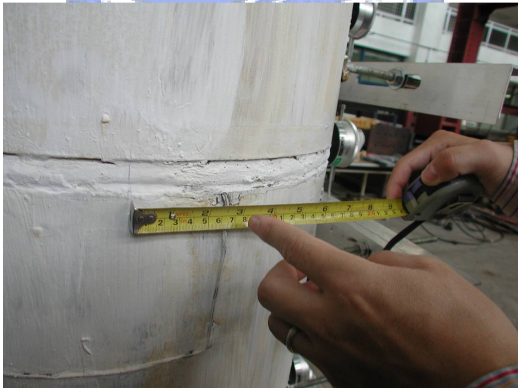
照片 3.30 試體 2 第一、二節塊間裂痕持續增長( \theta = -0.009 弧度)
