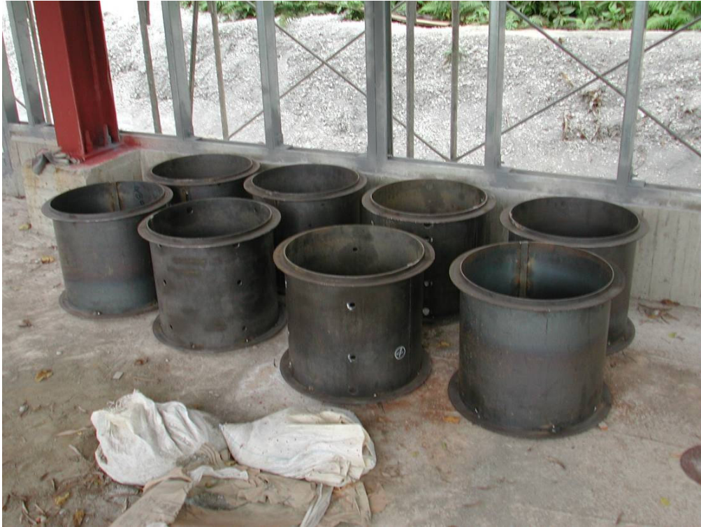
照片 3.1 節塊鋼套管
