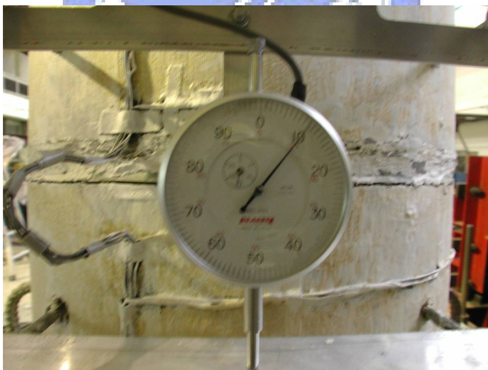
照片 3.96 試體 3 第一、二節塊間撓曲裂縫( \theta = +0.06 弧度)
