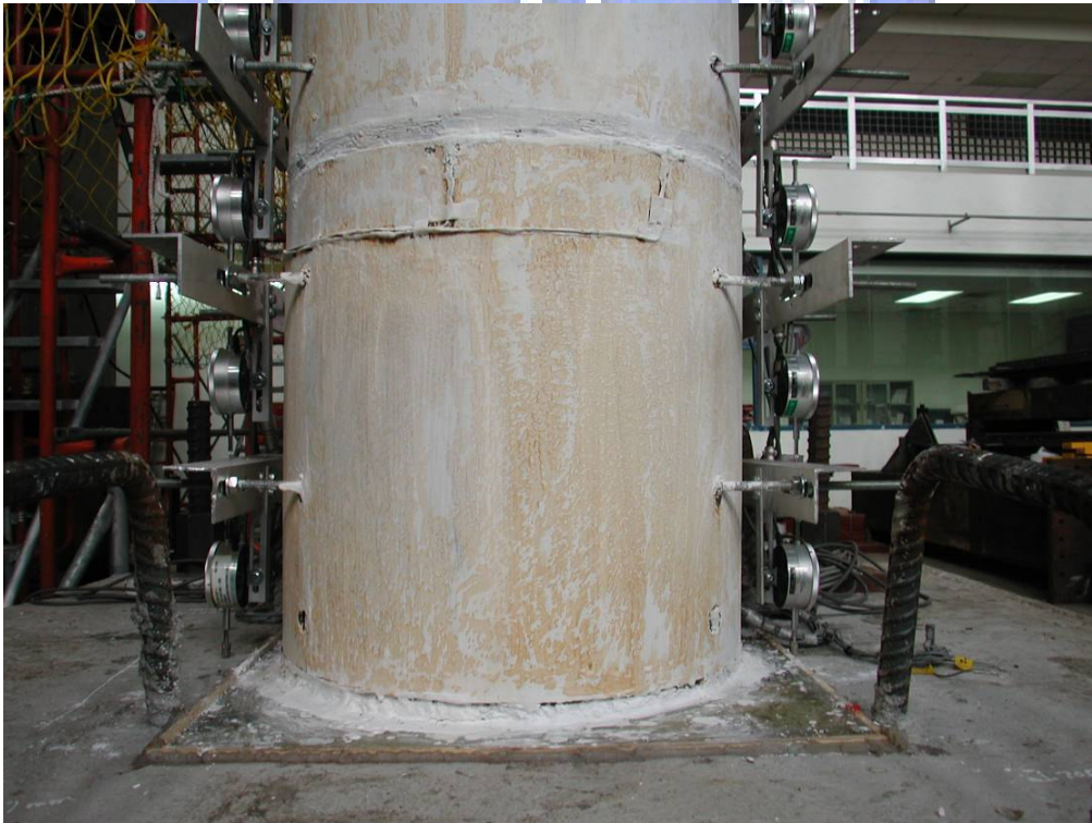
照片 3.68 試體 3 第一節塊柱底混凝土裂縫長度( \theta = +0.015 弧度)
