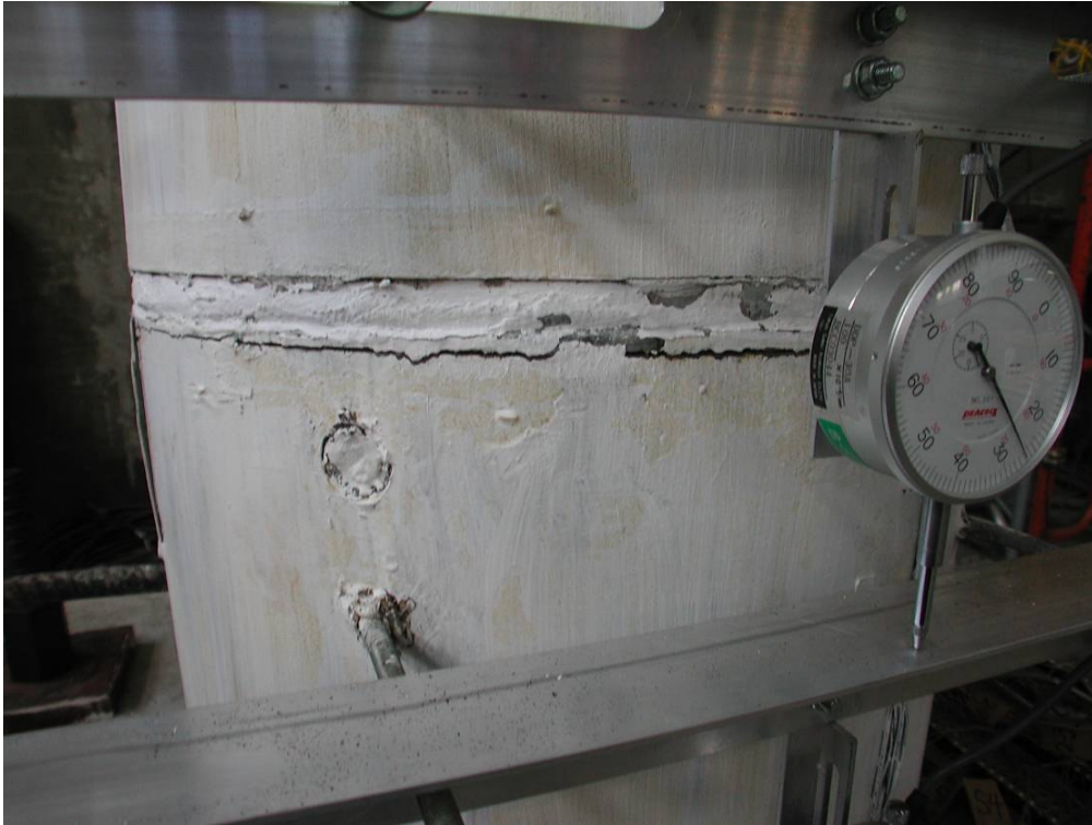
照片 3.33 試體 2 第一、二節塊間撓曲裂縫( \theta = -0.015 弧度)
