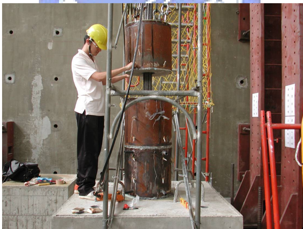
照片 3.20 試體 2 第三節塊吊裝
