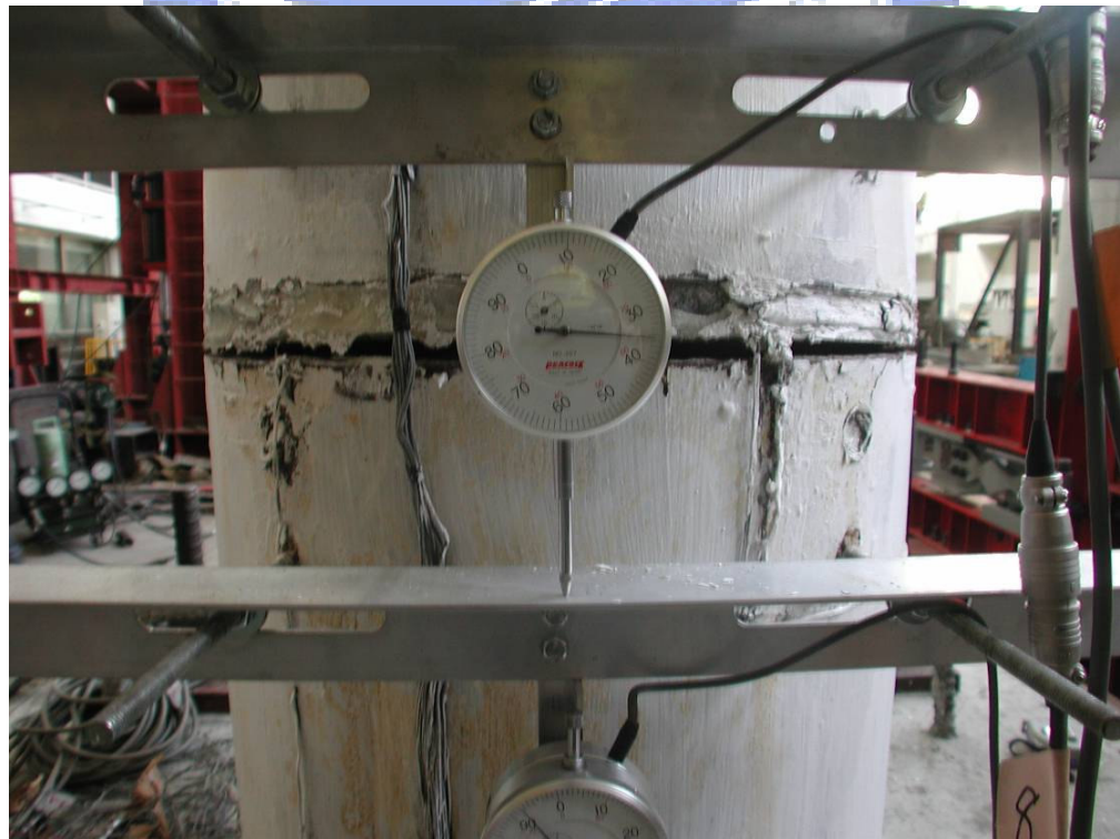
照片 3.48 試體 2 第一、二節塊間撓曲裂縫( \theta = +0.05 弧度)
