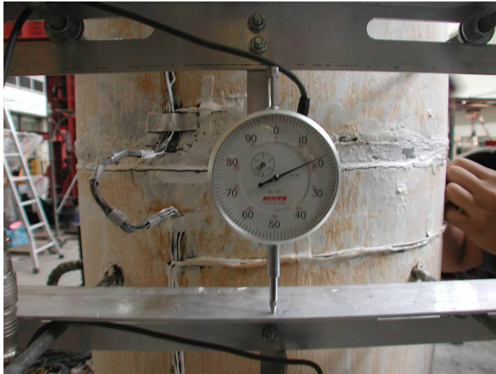
照片 3.73 試體 3 第一、二節塊間撓曲裂縫( \theta = +0.02 弧度)
