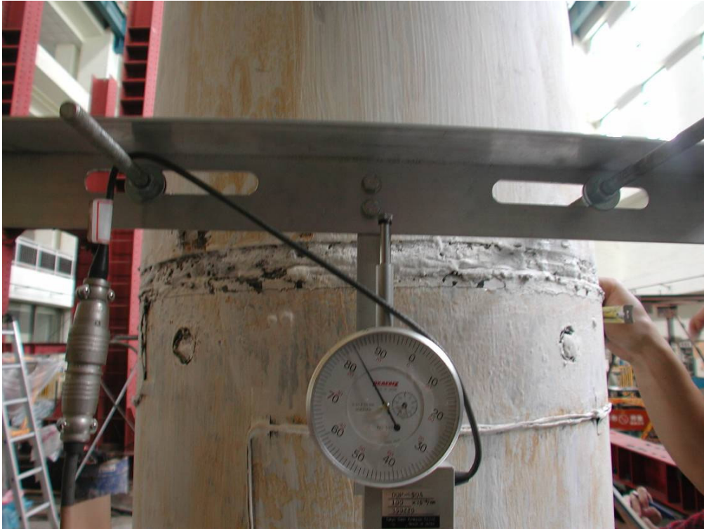
照片 3.75 試體 3 第二、三節塊間混凝土開始有裂痕產生( \theta = +0.02 弧度)
