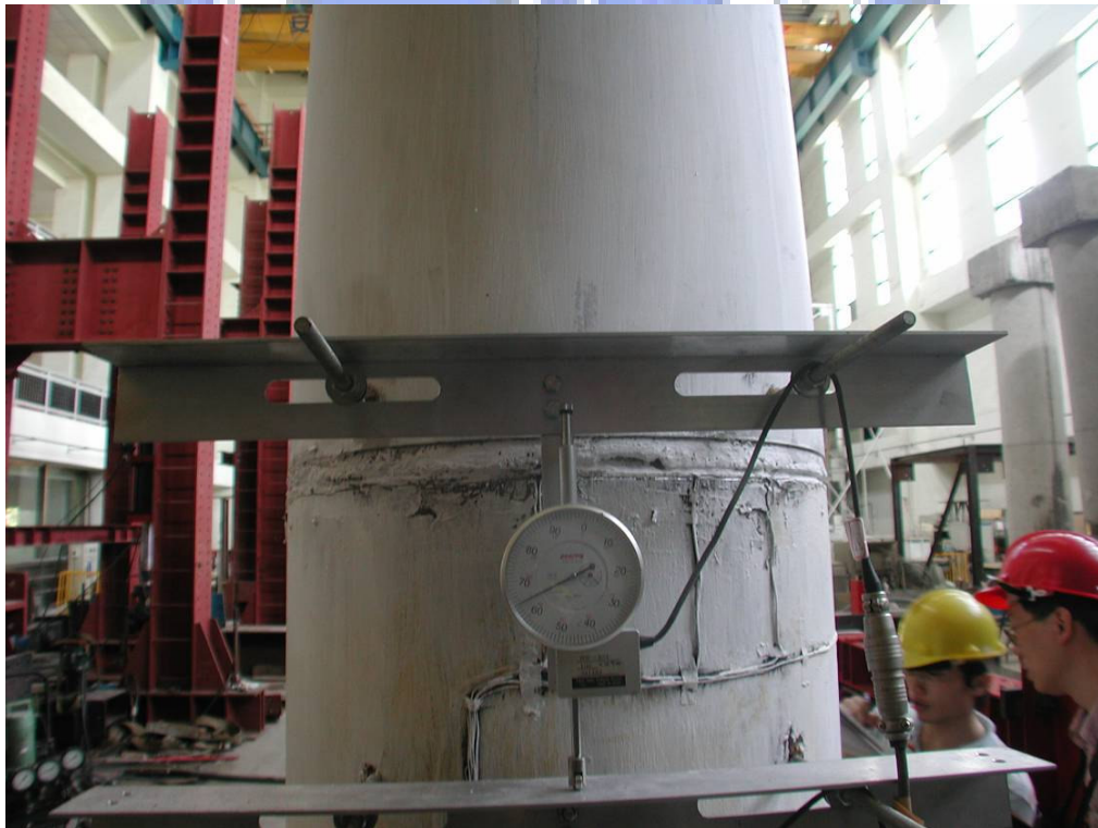
照片 3.46 試體 2 第二、三節塊間撓曲裂縫( \theta = +0.04 弧度)
