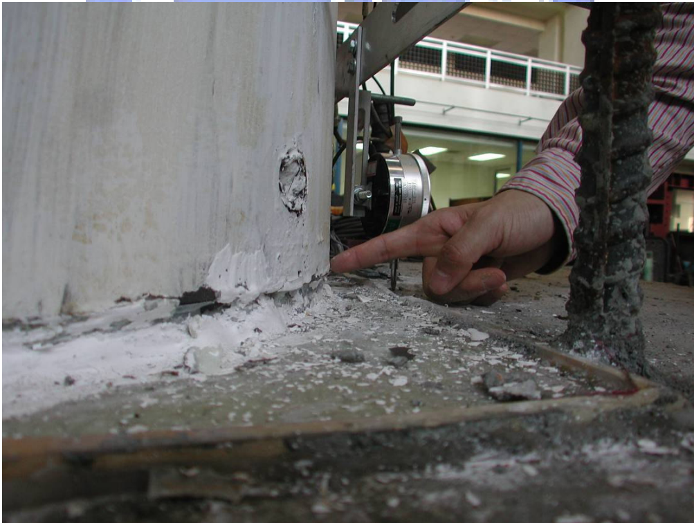
照片 3.60 試體 2 試驗後第一節塊鋼套管底部變形
