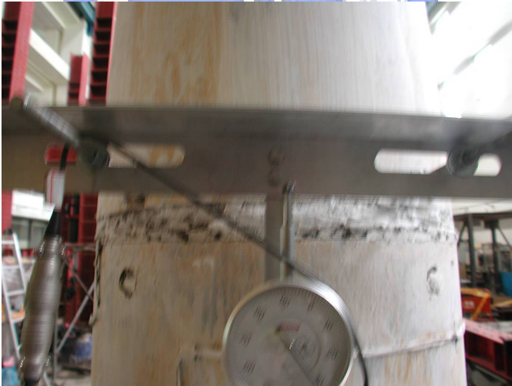
照片 3.92 試體 3 第二、三節塊間撓曲裂縫( \theta = +0.05 弧度)
