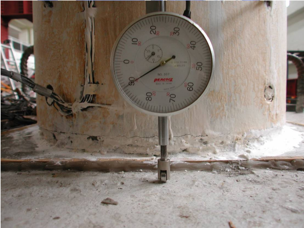
照片 3.62 試體 3 第一節塊柱底產生些微裂痕( \theta = +0.006 弧度)
