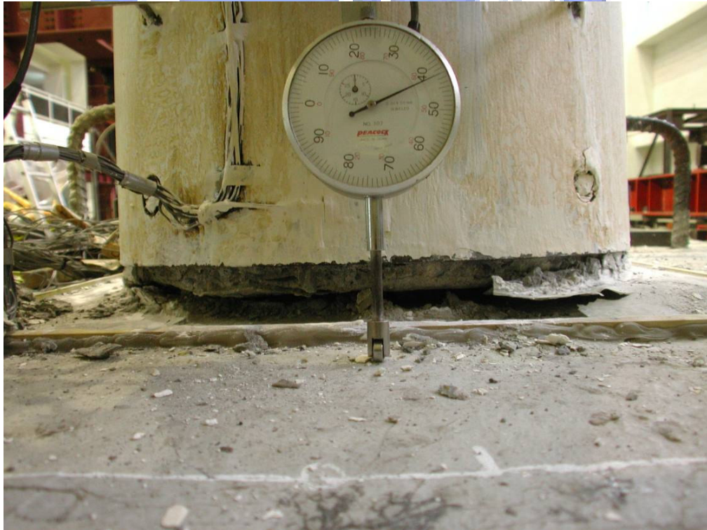
照片 3.94 試體 3 第一節塊柱底撓曲裂縫( \theta = +0.06 弧度)
