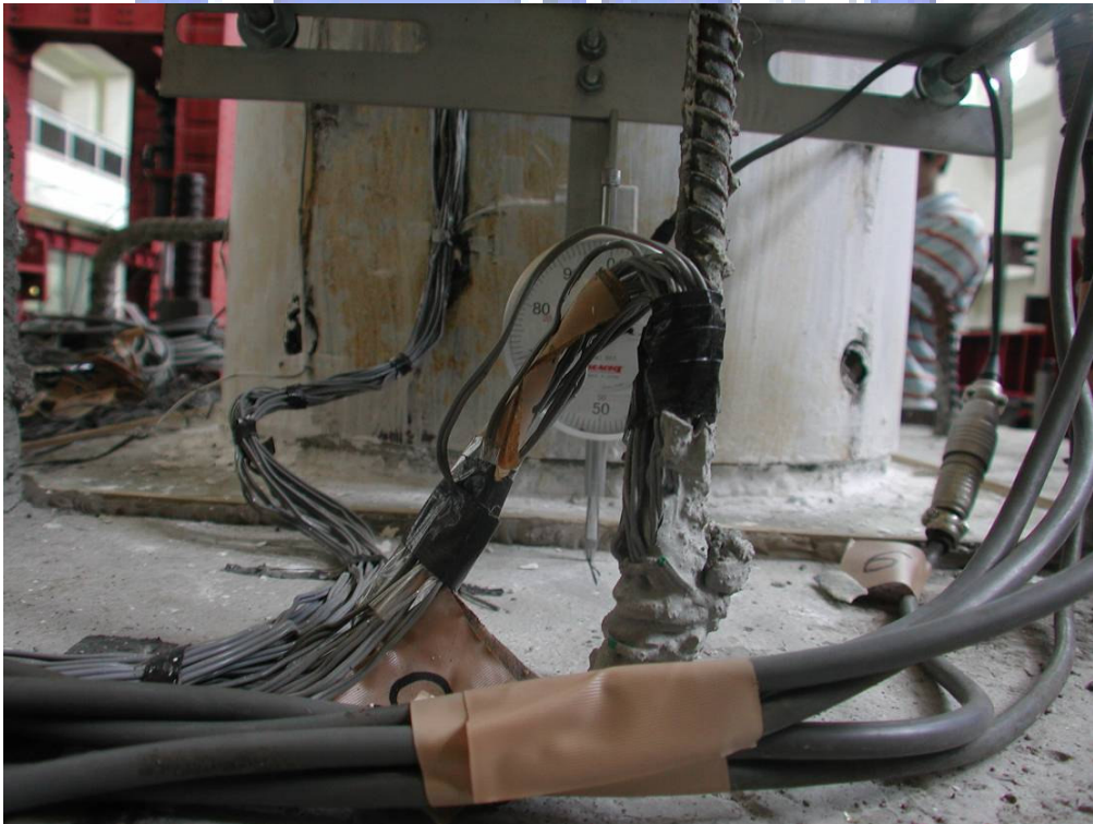
照片 3.38 試體 2 柱底混凝土裂痕( \theta = +0.03 弧度)
