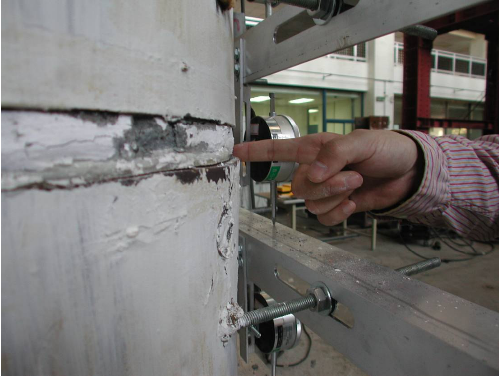
照片 3.59 試體 2 試驗後第一節塊鋼套管頂部變形
