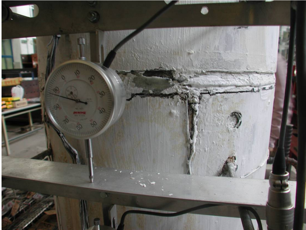
照片 3.35 試體 2 第一、二節塊間撓曲裂縫( \theta = +0.02 弧度)
