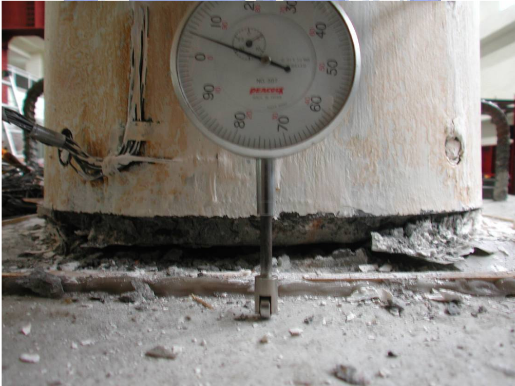
照片 3.88 試體 3 第一節塊柱底撓曲裂縫( \theta = +0.05 弧度)
