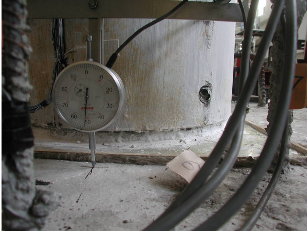
照片 3.31 試體 2 柱底部些微裂痕產生( \theta = +0.015 弧度)
