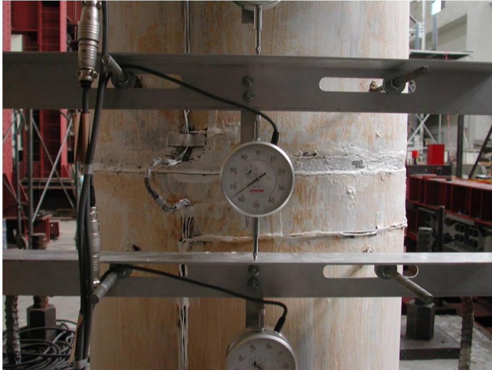
照片 3.69 試體 3 第一、二節塊間撓曲裂縫( \theta = +0.015 弧度)
