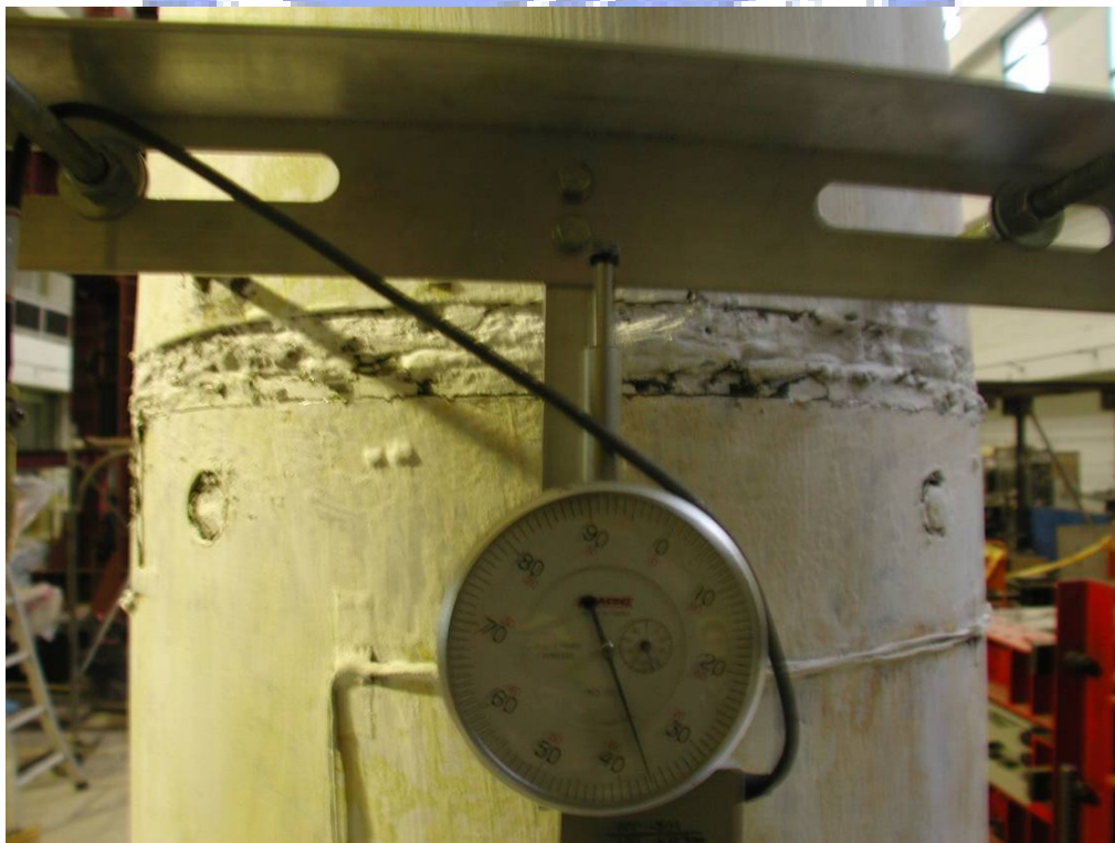
照片 3.98 試體 3 第二、三節塊間撓曲裂縫( \theta = +0.06 弧度)
