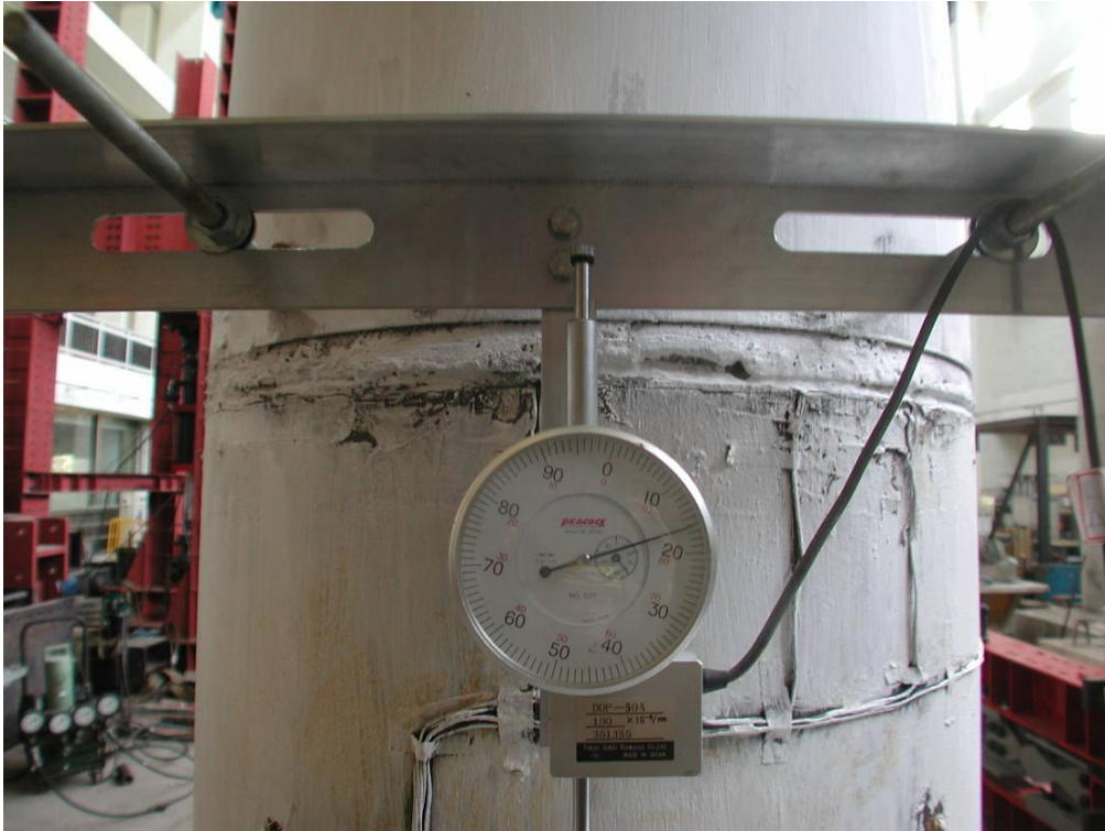
照片 3.37 試體 2 第二、三節塊間混凝土裂痕產生( \theta = +0.02 弧度)
