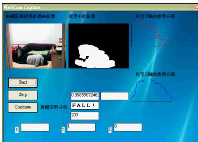
圖 37. 跌倒事件—躺臥姿勢，最後系統判斷為跌倒
