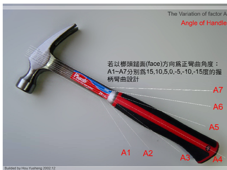
圖 5-3 實驗榔頭握柄角度彎曲設計
