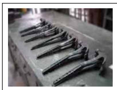
圖 5-7 熱處理之後的實驗榔頭半成品
