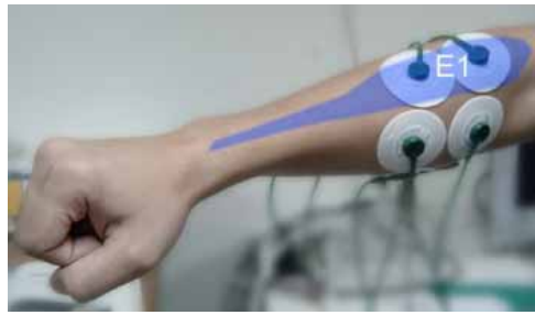
圖 3-9 肌力分佈實驗之肌電測量電極 E1 黏貼位置
