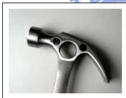
圖 5-9 以挖孔的方式減輕鎚頭的重量
