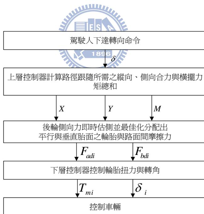
圖 1.1 控制系統流程方塊圖
