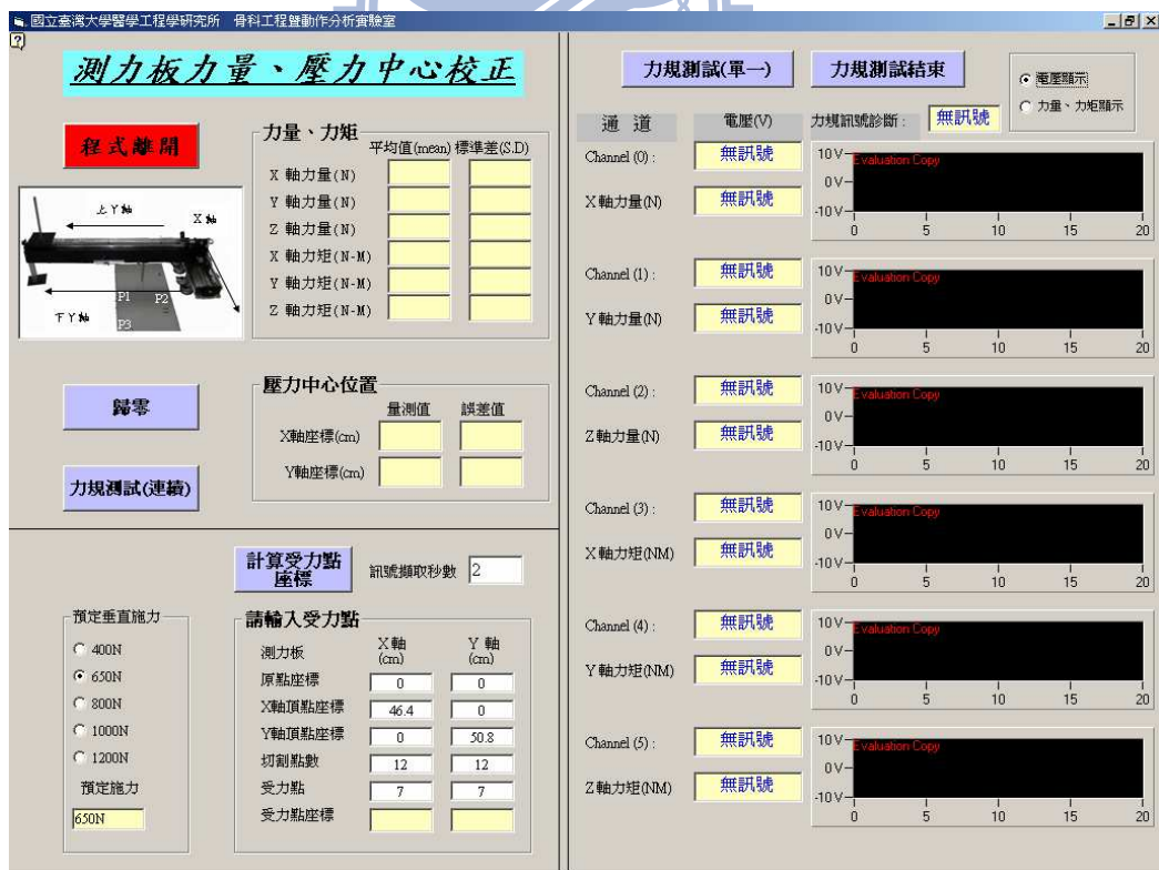
圖 2-13 測力板力量力矩擷取人機介面
