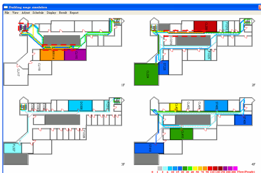
圖 45 基本案例通道網格累積流量模擬結果
