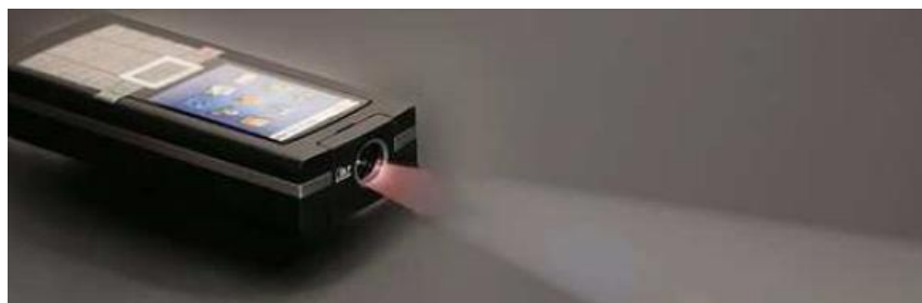
圖 28 配備微機電投影功能的手機
