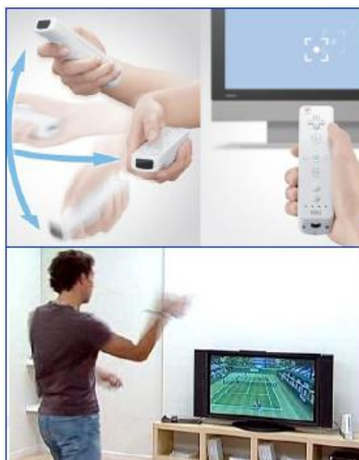
圖 24 配備慣性感測計的 Wii 遊戲控制器
