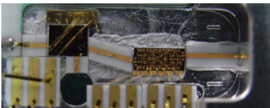
圖 2.8 傳送器採用銀膠製程構裝完成圖(二)
