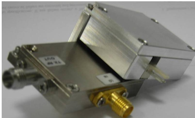
圖 3.35 60GHz 多晶片收發器與電壓調整氣組合圖
