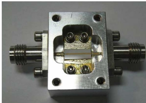
圖 2.28 合金共熔製程構裝模組與機械機構基座構裝圖
