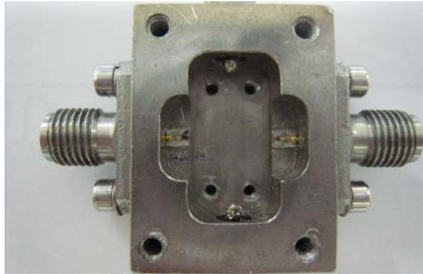
圖 2.27 合金共熔製程構裝機械機構基座完成圖
