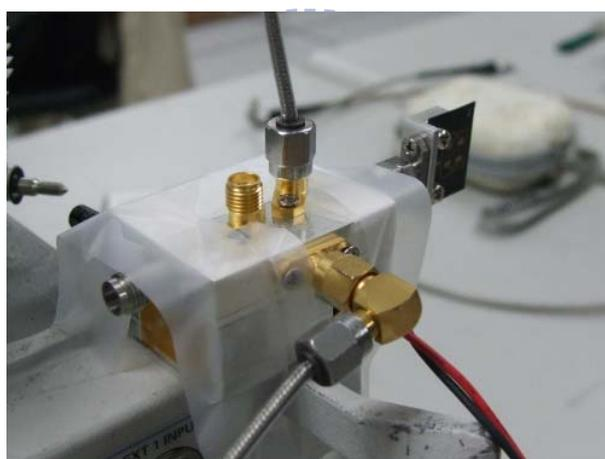
圖 3.37 發射器模組與 60GHz 天線整合圖
