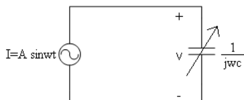
圖 3.1 可變電容外加交流電路圖
