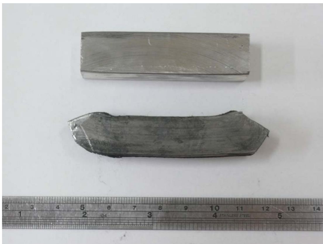
圖 4-7 ECAE 前後試棒形狀的變化。
