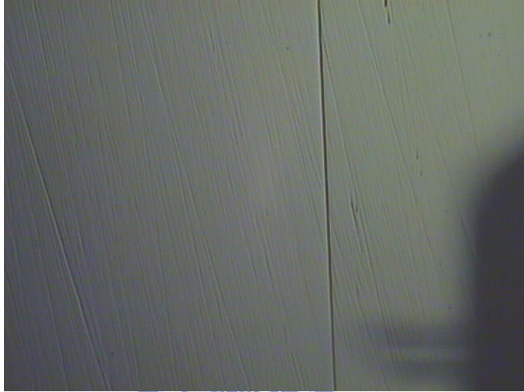
圖 5-6：對貼研磨試片經鑽石砂紙拋光後，試片表面的光學顯微鏡影像。
