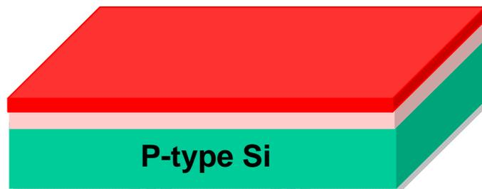
圖 3-8、在  $\text{SiO}_2$  試片上沉積 APTES。
