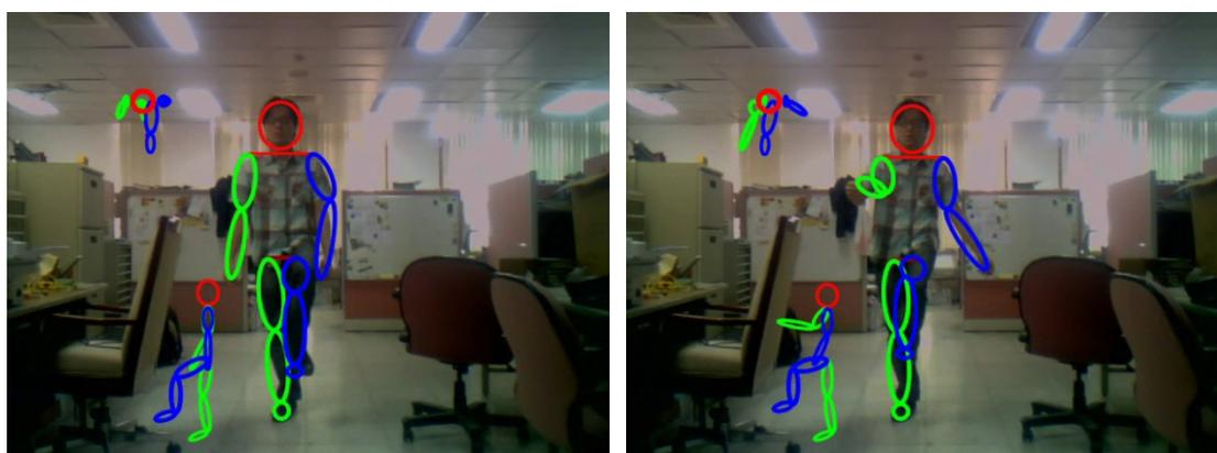
圖 6.6 腳部部分重疊的偵測結果。
