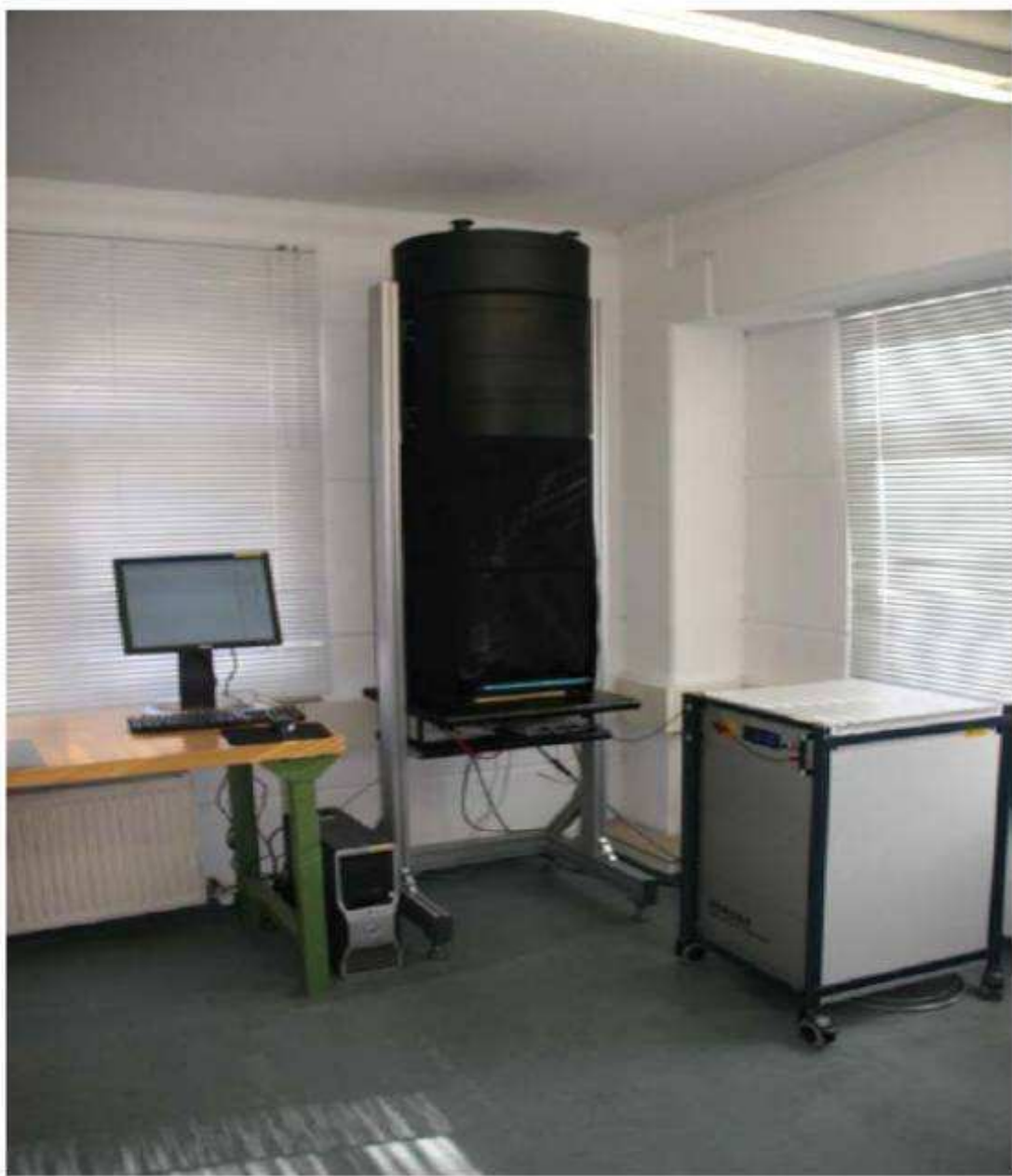
圖3-5：太陽能電池 I-V 電性測量設備 資料來源：德國 BERGER Lichttechnik 公司
