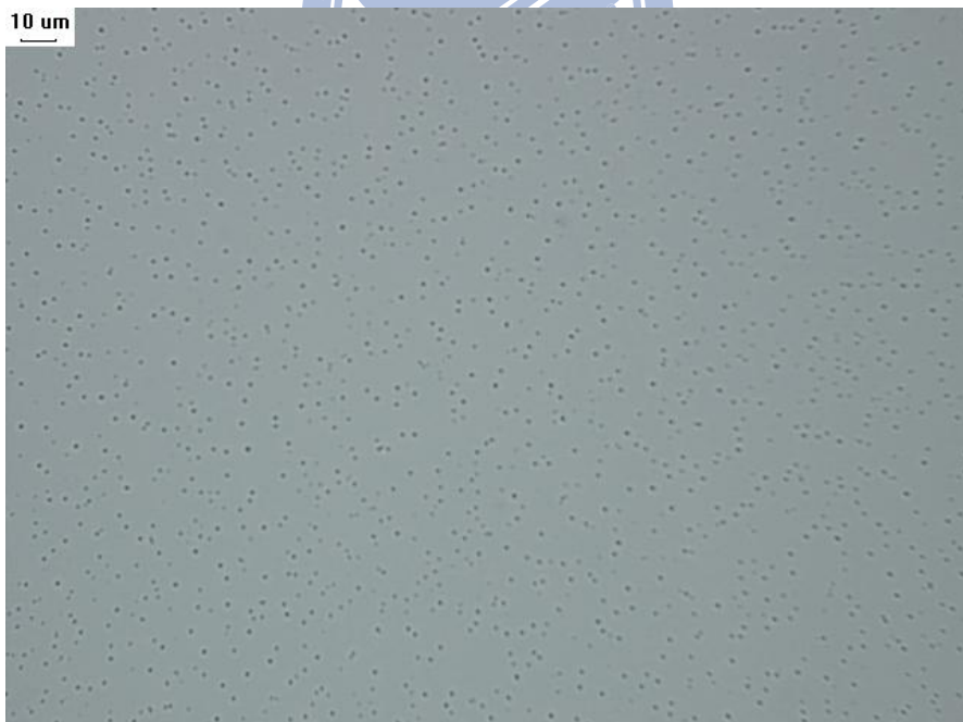
圖 4.5 未經非晶化佈植 600°C 退火後矽化鎳薄膜之光學顯微鏡表面觀察。
