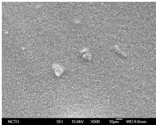
(c) \text{TiO}_2 表面型態放大倍率 500 倍
