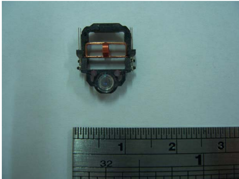
圖 3.1.2 光碟讀取頭線圈繞組與物鏡(質量塊)與細金屬絲(彈簧)
