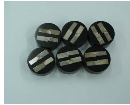
(a) 熱鑲埋機(Struers LaboPress-3) (b) 鑲埋後之試片腐蝕完成圖
