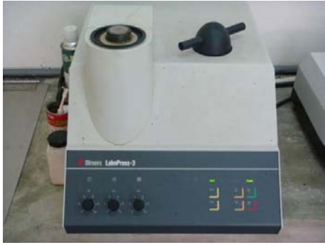
(a) 熱鑲埋機(Struers LaboPress-3) (b) 鑲埋後之試片腐蝕完成圖
