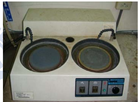
(a) 拋光機(Jean Wiriz PHOENIX) (b) 研磨機(MATASERV 2000)
