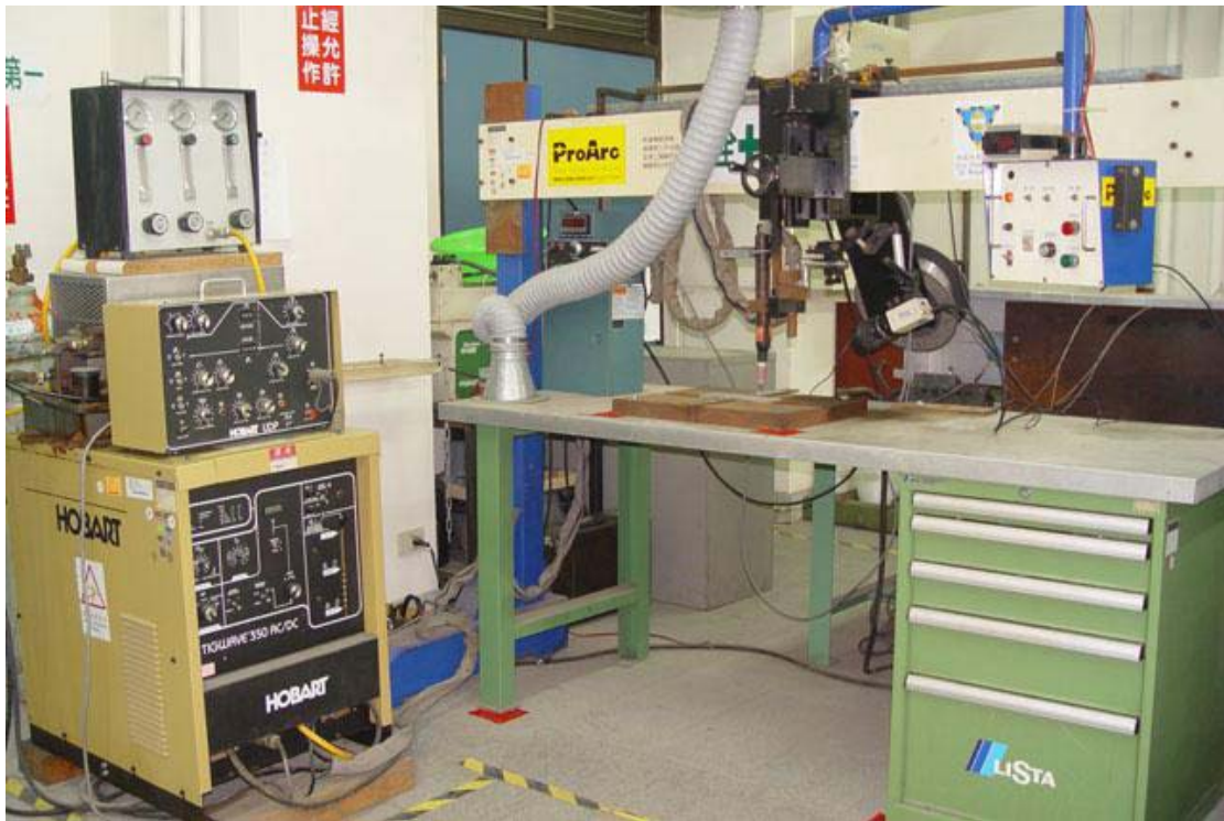
圖3-3 HOBART TIGWAVE 350氬銲機與ProArc 數位控制銲接檯車
