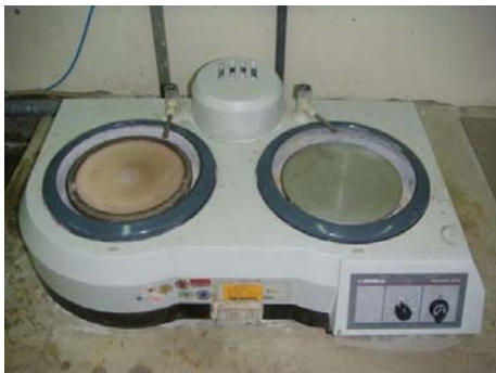
(a) 拋光機(Jean Wiriz PHOENIX) (b) 研磨機(MATASERV 2000)
