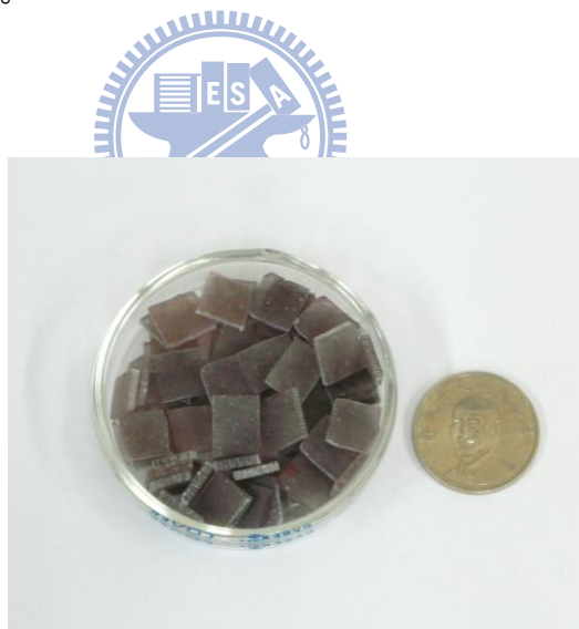
圖 4.15 穿透導電性量測試片實體圖(未經磁場處理、纖維長度 1mm) 鍍鎳碳纖維長度 1mm，0.1~0.6wt%+環氧樹脂，試片尺寸(10mm×10mm × 2mm)，每一組共 64 片。
