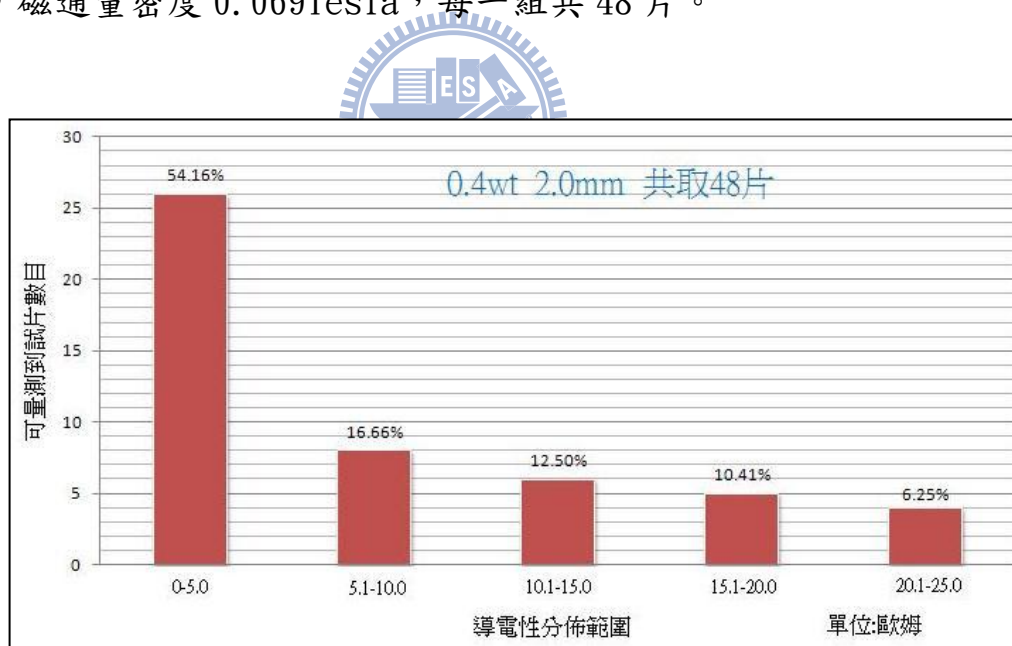
圖 4.20 0.4wt%+環氧樹脂經磁場處理穿透導電性量測結果 鍍鎳碳纖維長度 2mm，0.4wt%+環氧樹脂，磁通量密度 0.069Tesla，扭矩 (250kgf-cm)，量測時間(30sec)，取最小值。
