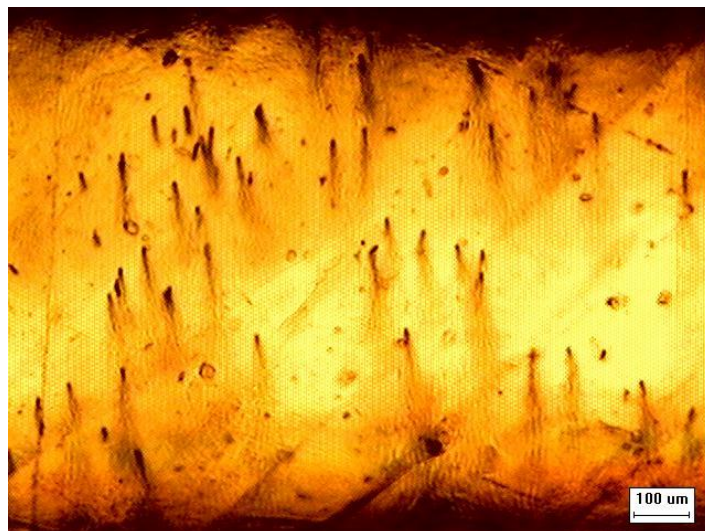
圖 4.11 磁場誘發纖維配向處理試片圖(未含冷卻系統、未含邊緣效應) 鍍鎳碳纖維 0.5wt%+環氧樹脂,纖維長度 1mm,直徑 10\mu\text{m} ,試片尺寸(100mm x54mmx2mm),磁通量密度 0.069Tesla,圖 (b) ~ (c): 50x。
