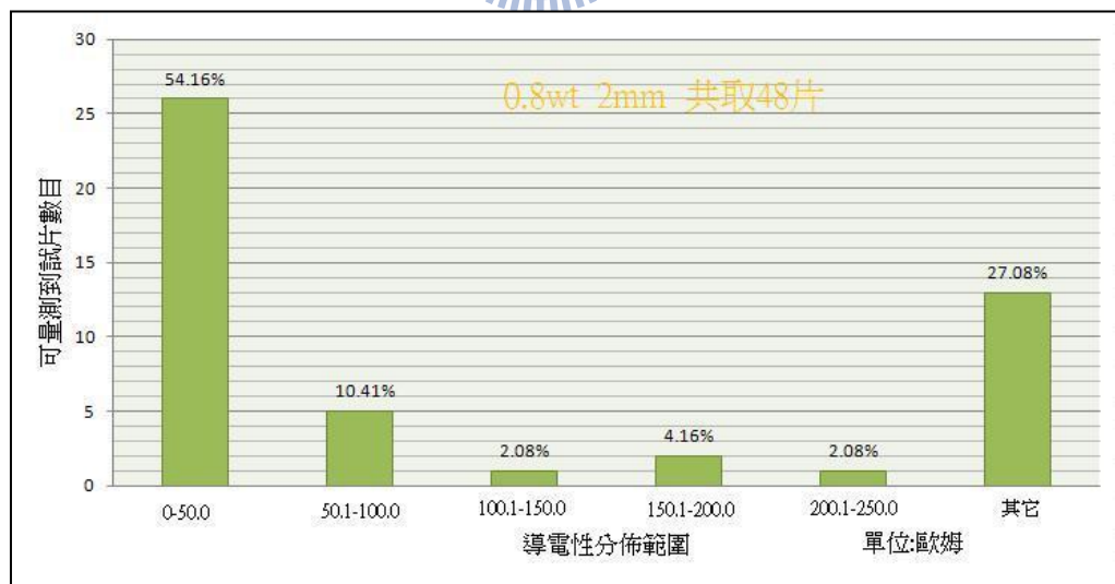
圖 4.22 0.8wt%+環氧樹脂經磁場處理穿透導電性量測結果 鍍鎳碳纖維長度 2mm，0.8wt%+環氧樹脂，磁通量密度 0.069Tesla，扭矩 (250kgf-cm)，量測時間(30sec)，取最小值。
