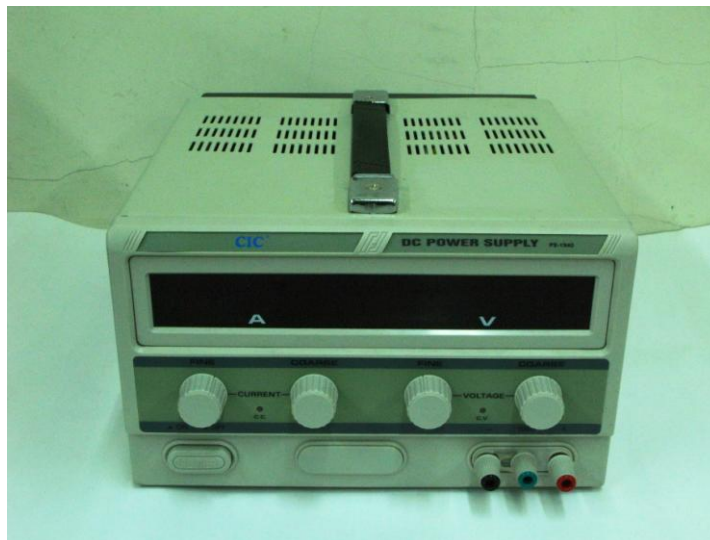
圖 3.7 直流電源供應器
