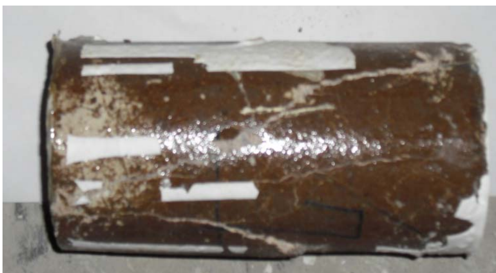
照片4-29 普通混凝土試體加熱至800°C急速冷卻並以環氧樹脂補強 經抗壓試驗後之外觀
