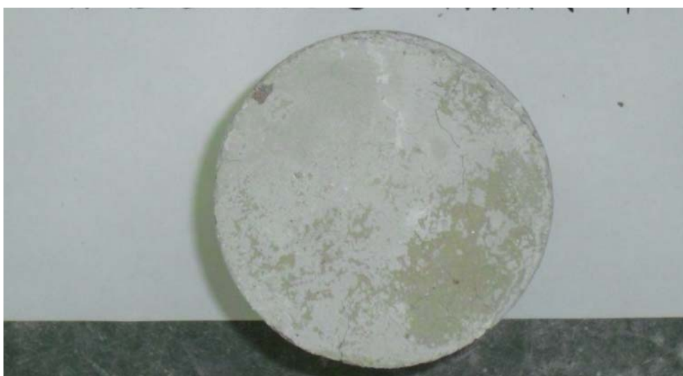
照片4-13 高強度混凝土試體加溫至600°C後自然冷卻頂面
