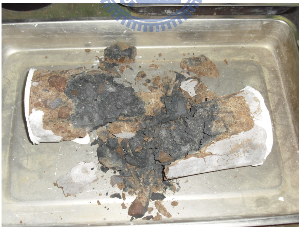
照片4-6 普通強度混凝土加溫至600°C後斷面顏色
