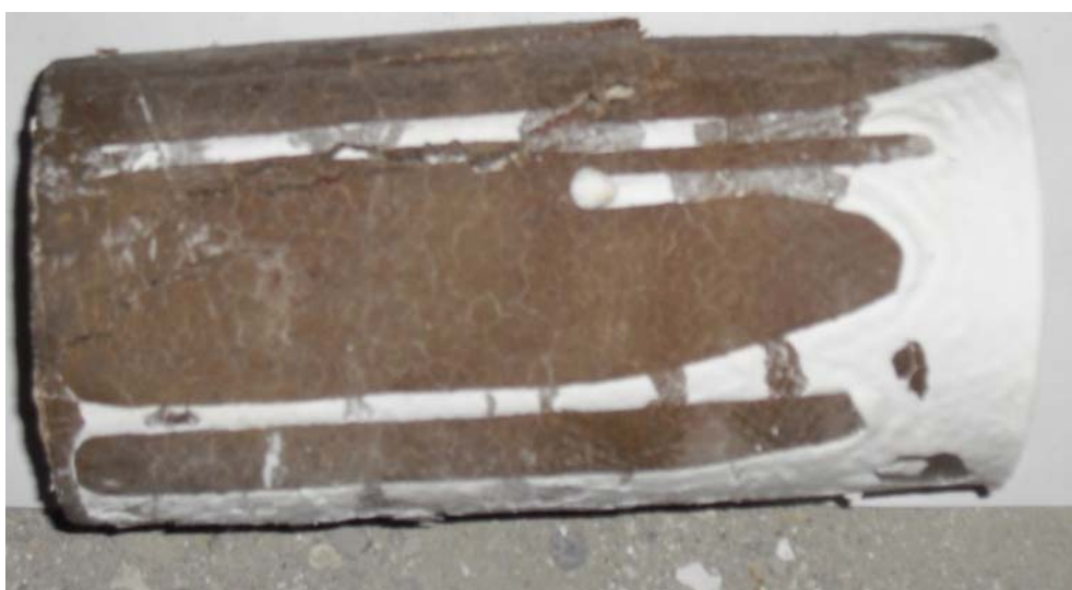
照片4-25 高強度混凝土試體加熱至800°C急速冷卻並以環氧樹脂補強經抗壓試驗後之外觀
