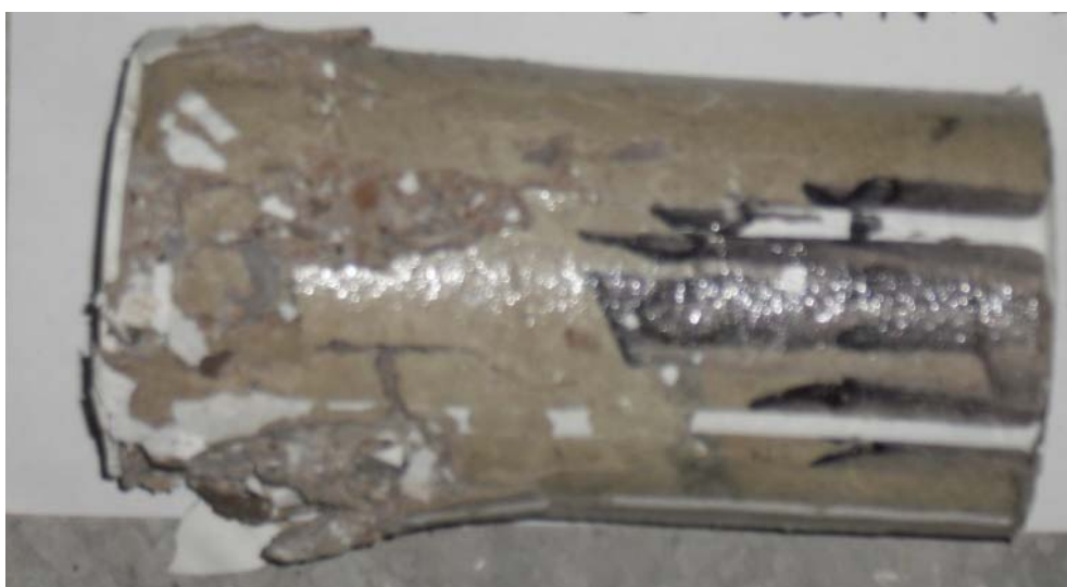
照片4-27 高強度混凝土試體加熱至600°C急速冷卻並以環氧樹脂補強經抗壓試驗後之外觀
