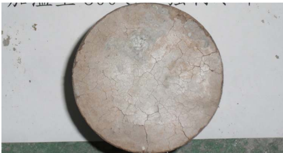
照片4-7 高強度混凝土試體加溫至800°C後急速冷卻頂面
