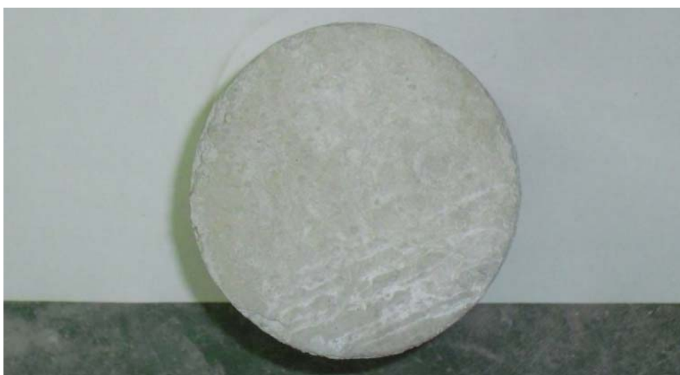
照片4-21 普通強度混凝土試體加溫至600°C後自然冷卻頂面
