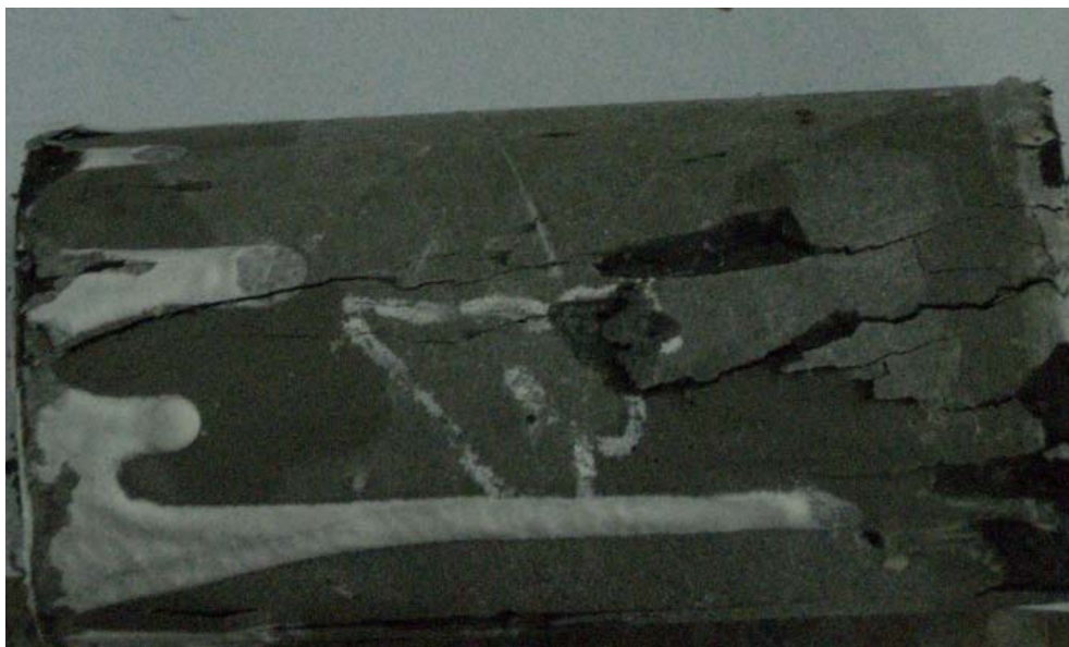
照片4-33 高強度混凝土試體破壞形態
