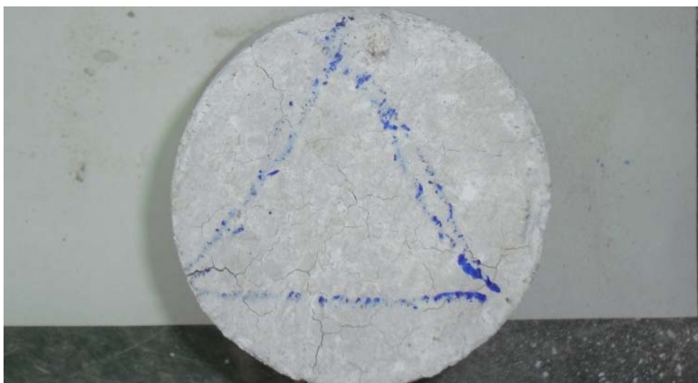
照片4-17 普通強度混凝土試體加溫至800°C後自然冷卻頂面
