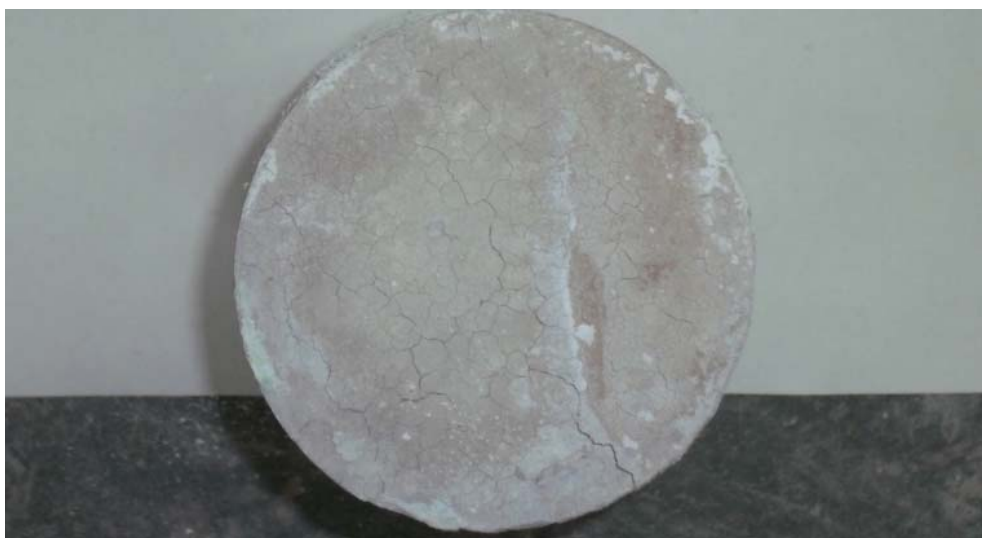
照片4-9 高強度混凝土試體加溫至800°C後自然冷卻頂面
