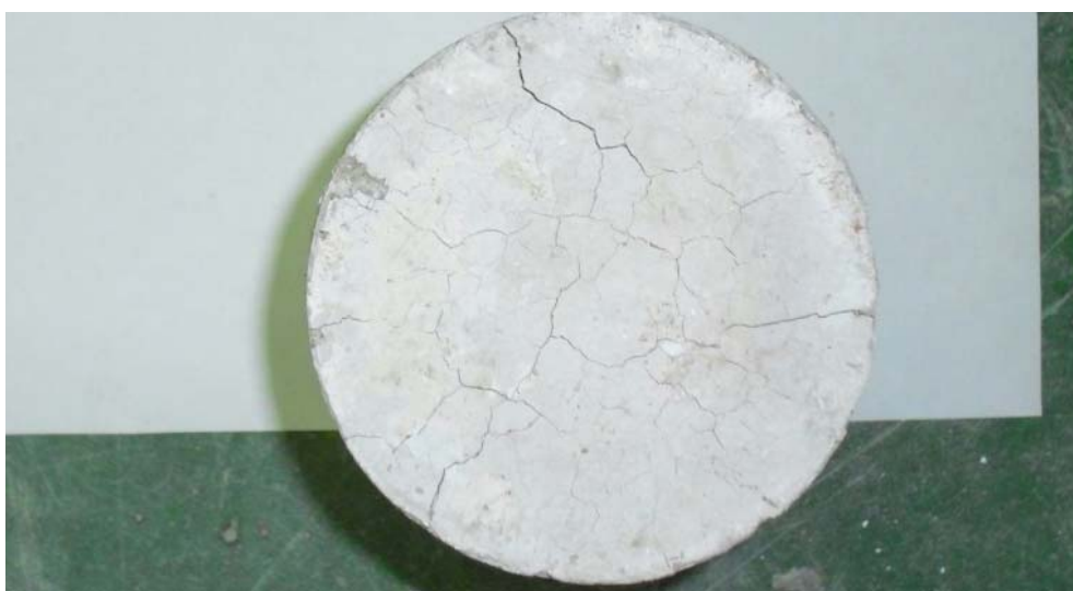
照片4-11 高強度混凝土試體加溫至600°C後急速冷卻頂面
