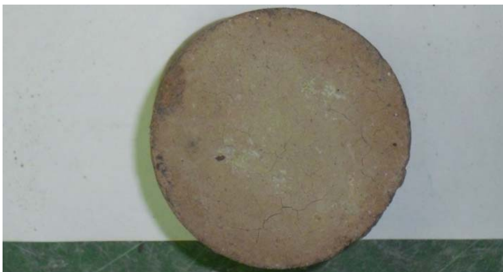
照片4-15 普通強度混凝土試體加溫至800°C後急速冷卻頂面
