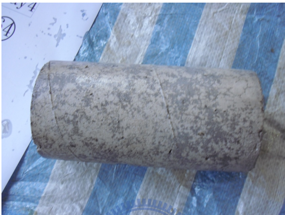
照片4-23 未經滯水再養護試體灌入環氧樹脂後之外觀
