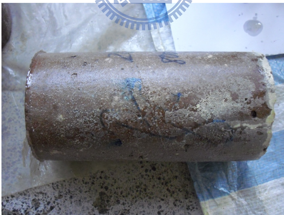
照片4-24 經滯水再養護試體灌入環氧樹脂後之外觀
