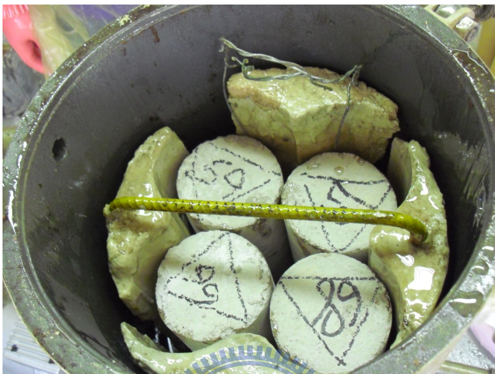
照片3-5 待補強混凝土試體放入環氧樹脂灌入儀之真空槽
