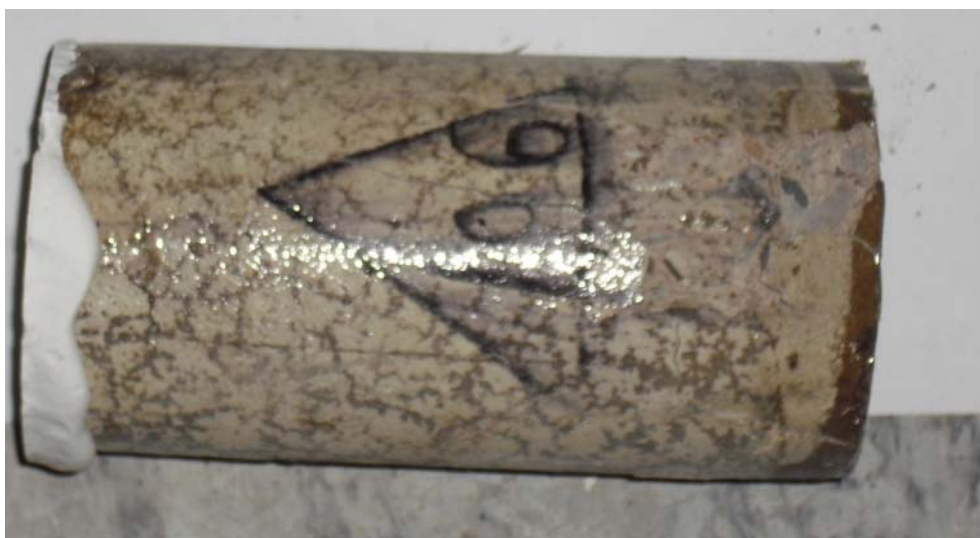
照片4-31 普通混凝土試體加熱至600°C急速冷卻並以環氧樹脂補強 經抗壓試驗後之外觀
