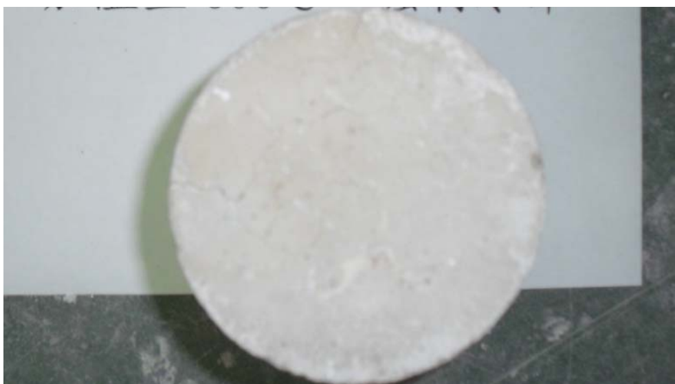
照片4-19 普通強度混凝土試體加溫至600°C後急速冷卻頂面
