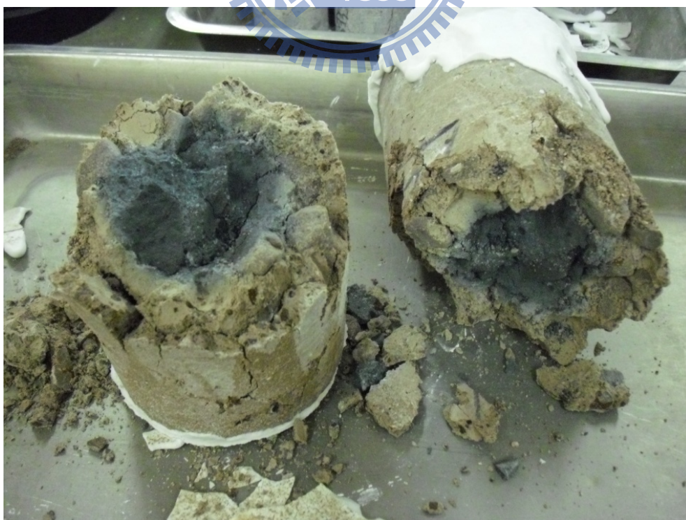
照片4-4 普通強度混凝土加溫至800°C後斷面顏色
