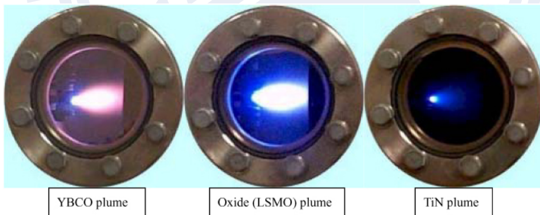
圖 2-10 可以從 plume 的顏色、尺寸與形狀得知靶材的種類
