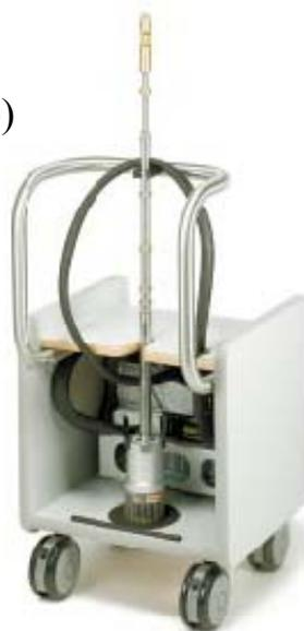
圖 3-1 PPMS 基本構造圖，(a)電腦控制系統、杜瓦瓶 (b) 3He 系統
