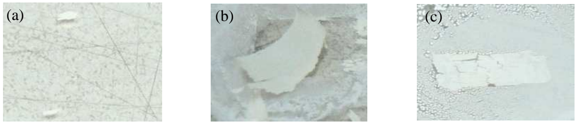
圖 4-1-3 不同濃度 TTIP 黏著狀況 (a) 0.01M (b) 0.1M TTIP (c) 0.5M TTIP
