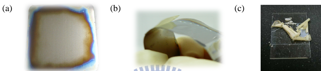
圖 4-1-1 (a) 短時間熱處理後基材氧化層顏色 (b) 剝除之 TNT 薄膜 (c) 黏著情況
