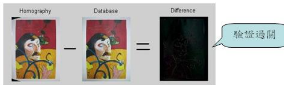
圖 9 Homography 驗證結果示意圖
