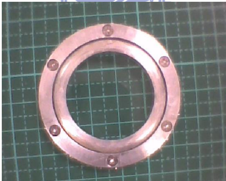
圖 2.4 利用螺絲將塑膠基板表面繃緊
