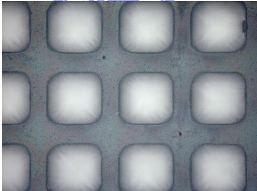
圖 2.10(b) 基板完成雷射加工後，正面的拍攝結果放大圖
