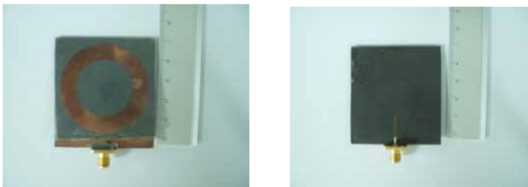
圖 3-14 R=26.5\text{mm} ， r=18\text{mm} ， L_s=10\text{mm} 環形洩漏波天線實體照相圖
