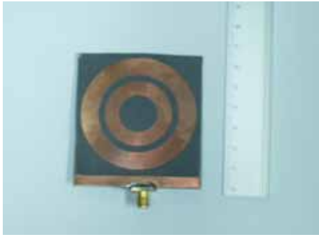
圖 3-29 串聯同心環，外環寬度=8.5mm，內環寬度=7mm 實體照相圖
