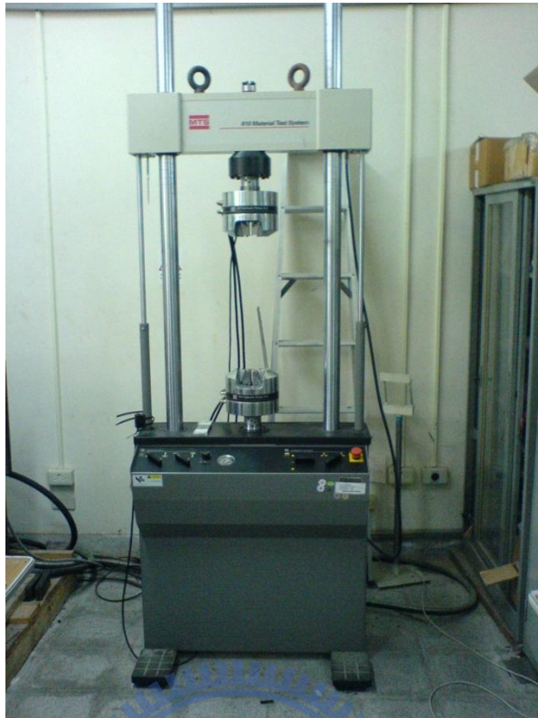
圖 10 MTS-810 拉伸試驗機
