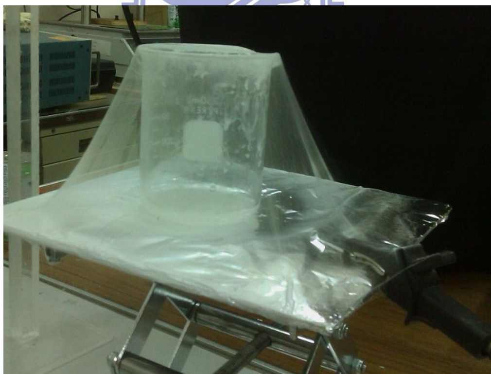
圖 4.1 利用燒杯做為高台收集不織布纖維膜情形
