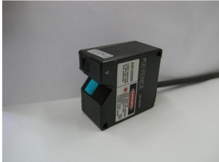
圖 3.4.1 雷射位移感測器實體圖
