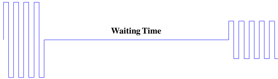
圖 4.5.6 從 Homeotropic state 達到灰階之電壓驅動設計
