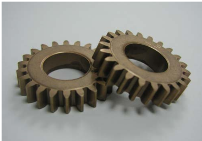
圖6.9(c) 實驗齒輪經銅熔滲之燒結品
