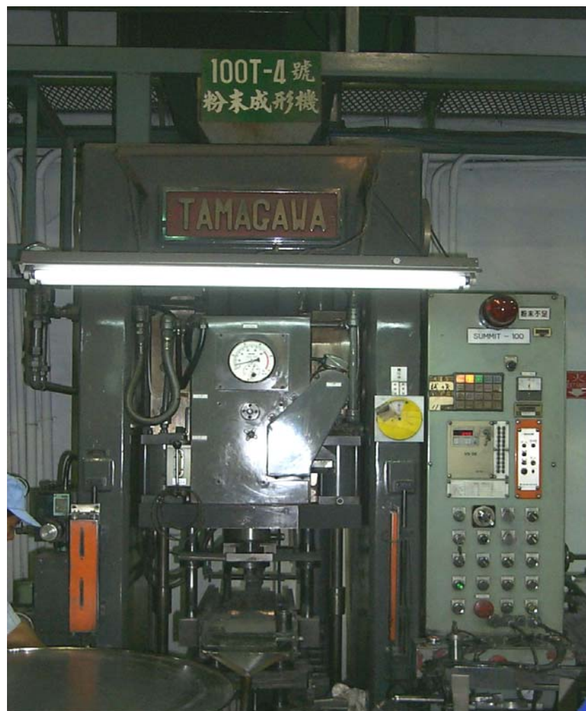
圖 6.2 100 噸氣壓式粉末成形機（日本 Tamagawa）
