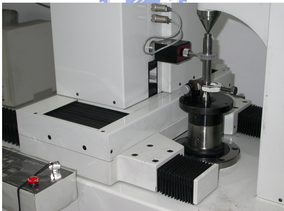
圖 6.5 TTi-300E—CNC 齒輪精度量測儀
