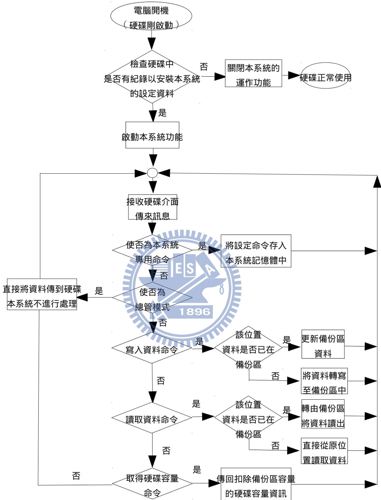
圖 7：還原卡系統工作流程圖
