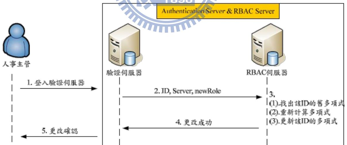
圖 13：存取控制系統流程圖
