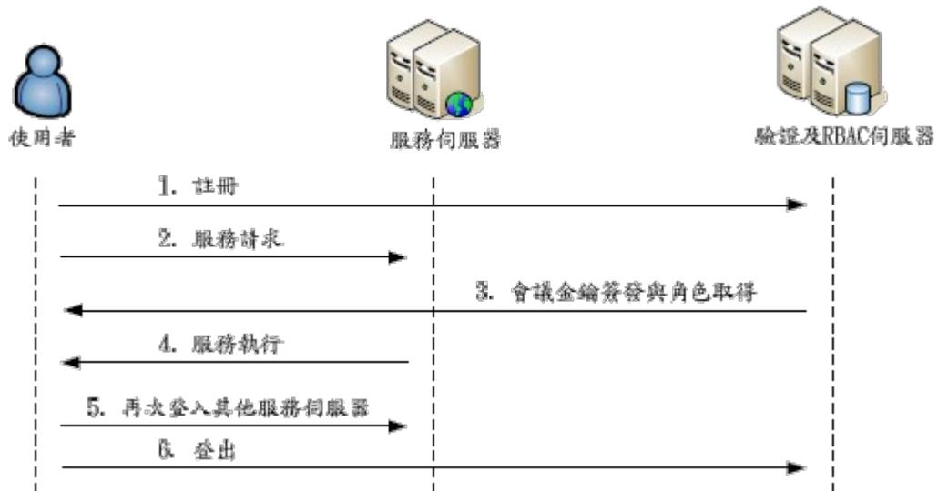
圖 12：存取控制系統流程圖
