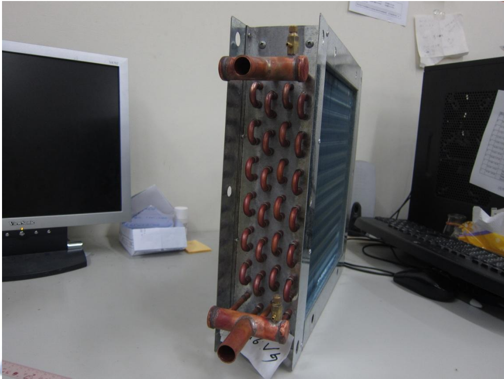
圖 4- 21 待測物實體之照片 (四排管)
