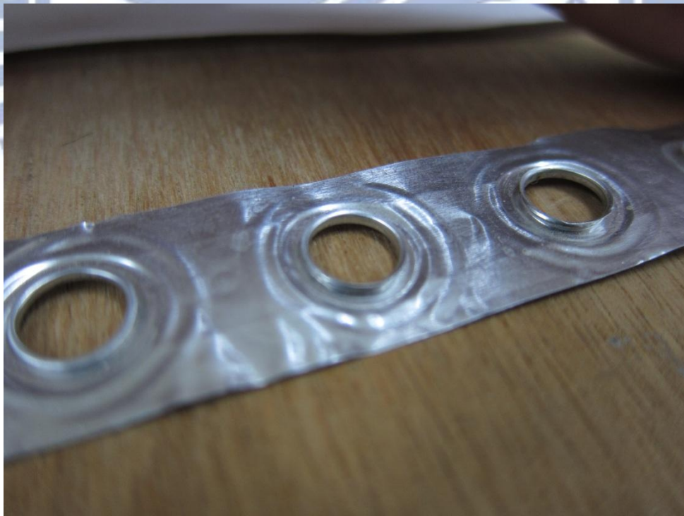
圖 4- 22 平板型鰭片實際照片
