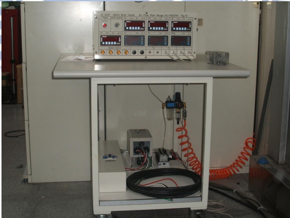
圖 4-4 實際控制面板與變頻器照片
