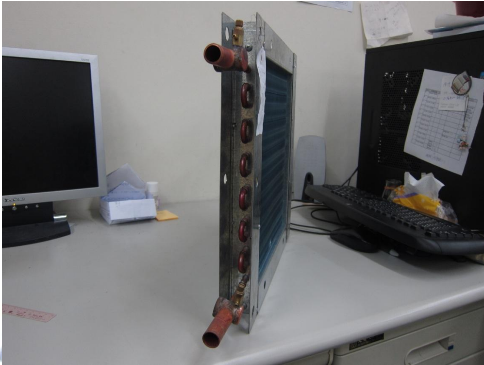
圖 4- 19 待測物實體之照片 (一排管)
