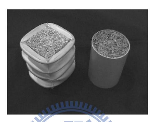
圖 1.4 空心管內填滿泡沫鋁之能量吸收裝置
