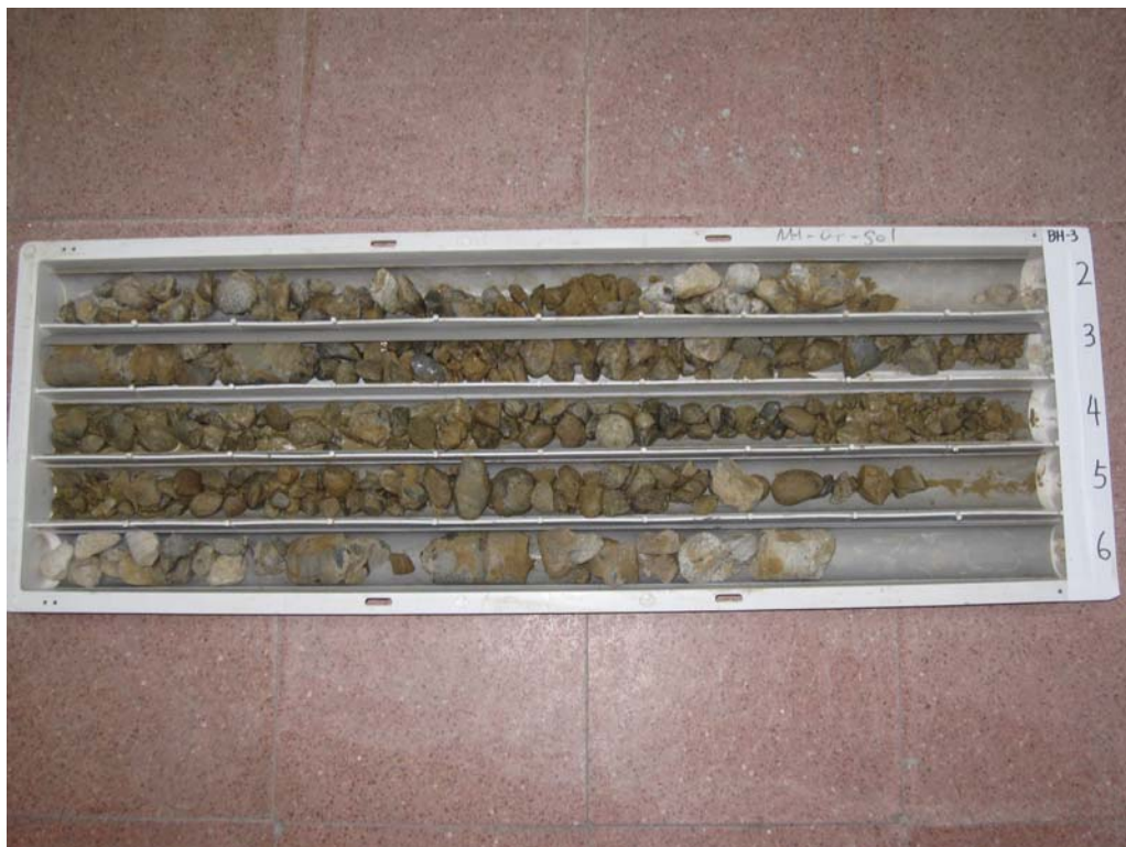
圖 4.25 BH3 鑽孔改良土取樣岩心相片
