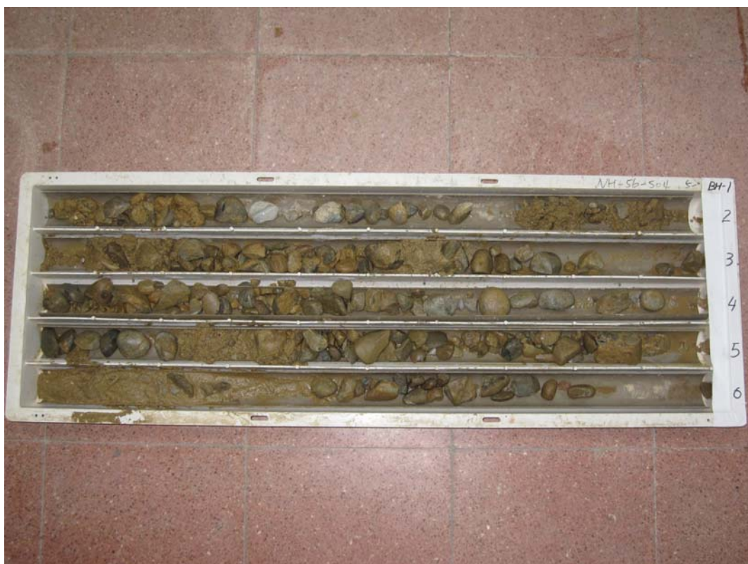
圖 4.23 BH1 鑽孔改良土取樣岩心相片
