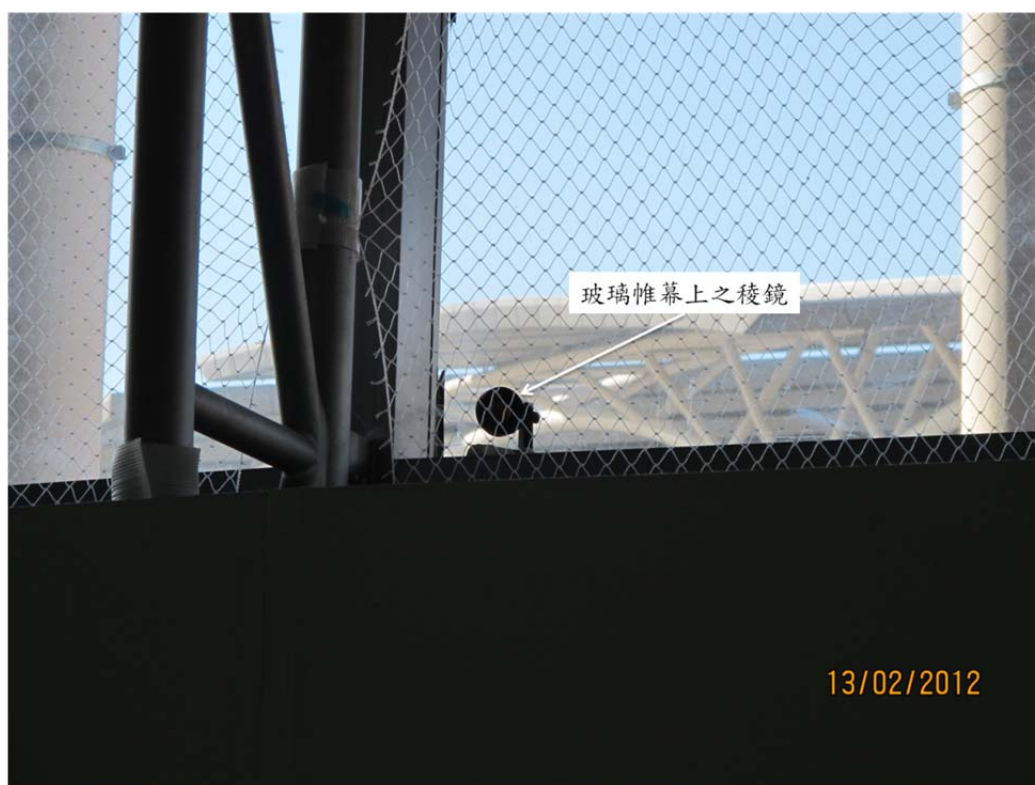
圖 3.20 高鐵站玻璃帷幕安裝監測垂直位移量的稜鏡
