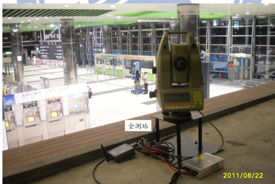
圖 3.21 高鐵站內監測玻璃帷幕稜鏡位移量的全站儀
