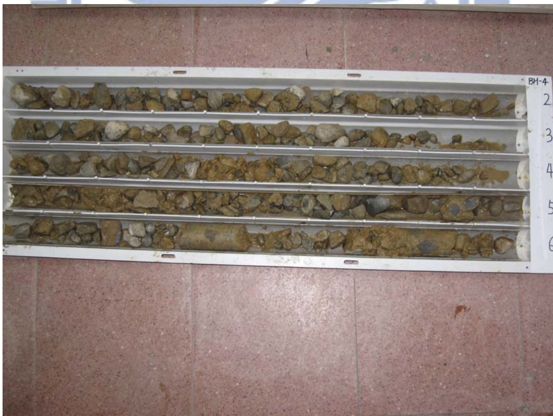
圖 4.26 BH4 鑽孔改良土取樣岩心相片
