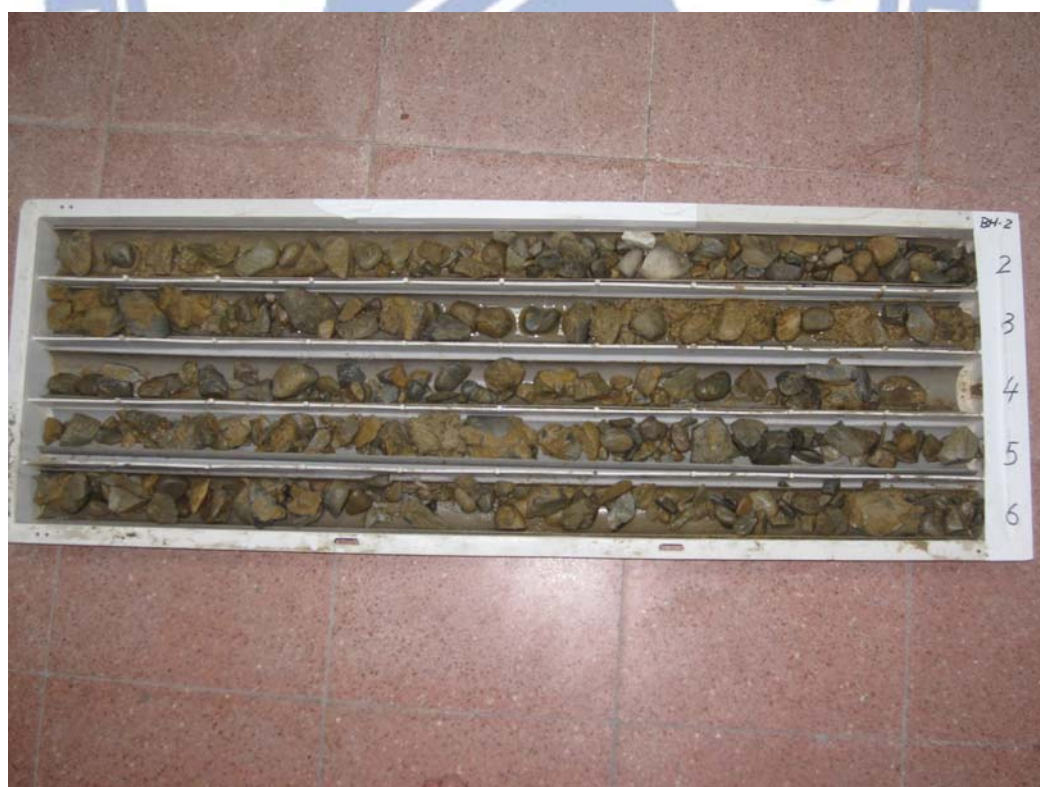
圖 4.24 BH2 鑽孔改良土取樣岩心相片
