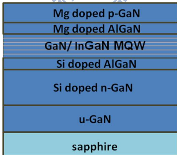
圖 3-5 LED 之磊晶結構示意圖
