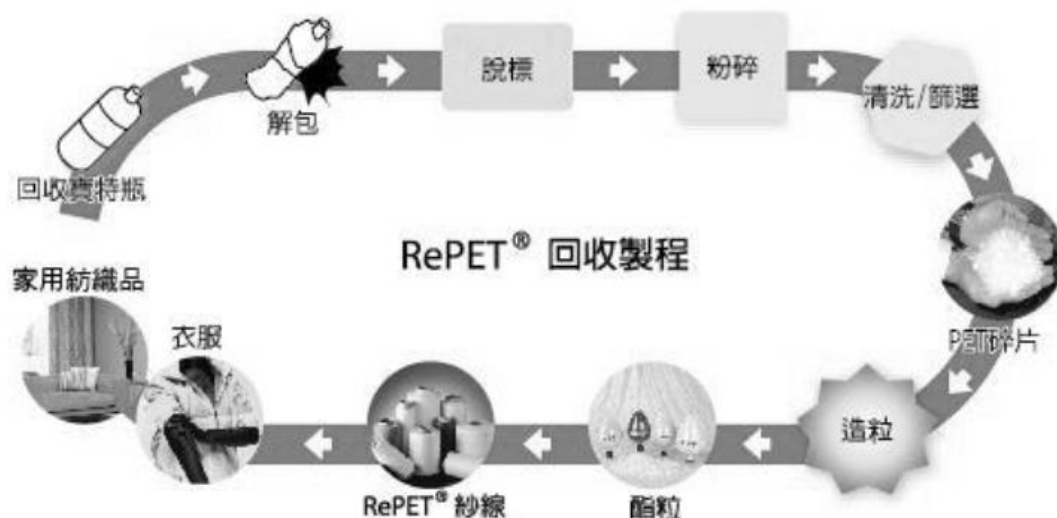
圖2-3 寶特瓶回收再生紡織品(RePET)製造流程
