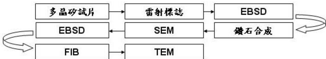
圖 3-28 鑽石高密度區域下的矽方位分析流程圖
