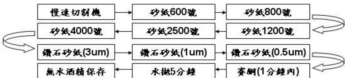
圖 3-13 試片研磨流程圖
