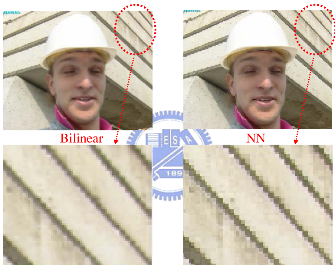
圖 6.2 本圖為針對 Foreman 影像先用 NN 取樣到 240*192 個點之後在分別用 Bilinear 和 NN 內插回 352*288 個像素點，上圖為內插後的影像圖，下圖則是上圖最右上角長寬各別放大四倍後的結果
