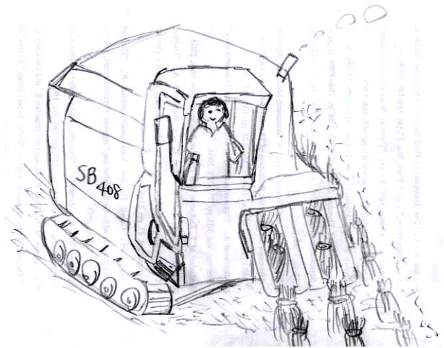
(b)可移動式稻草固態錠型燃料製作機開進田間自行進料
