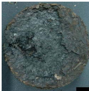
圖 3.2.9 溫度 250°C 熱壓成品之底部
