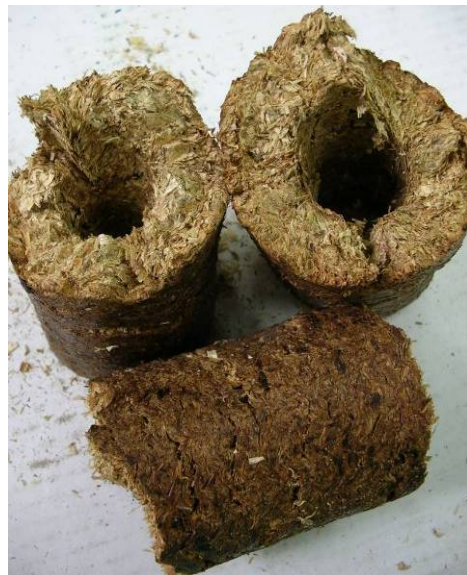
圖 4.2.11 連續成型之稻草固態錠型燃料
