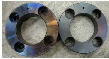
圖 4.2.9 模具加長 L 段；左為 25mm，右為 15mm
